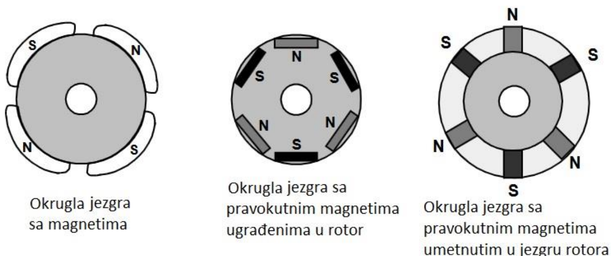
Slika 13. Poprečni presjek rotora BLDC elektromotora [10]
