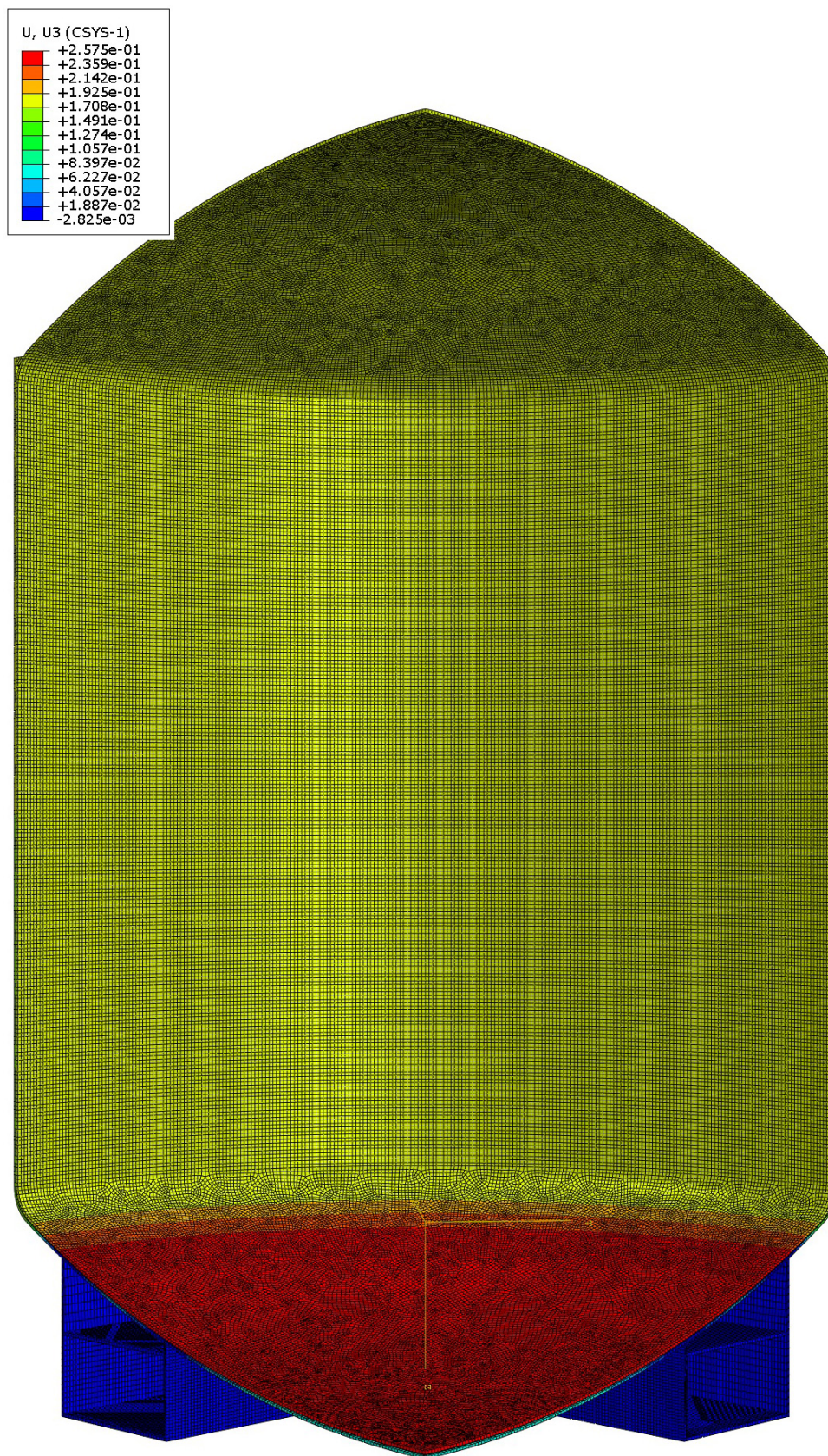
Slika 53. Raspodjela vertikalnog pomaka spremnika
