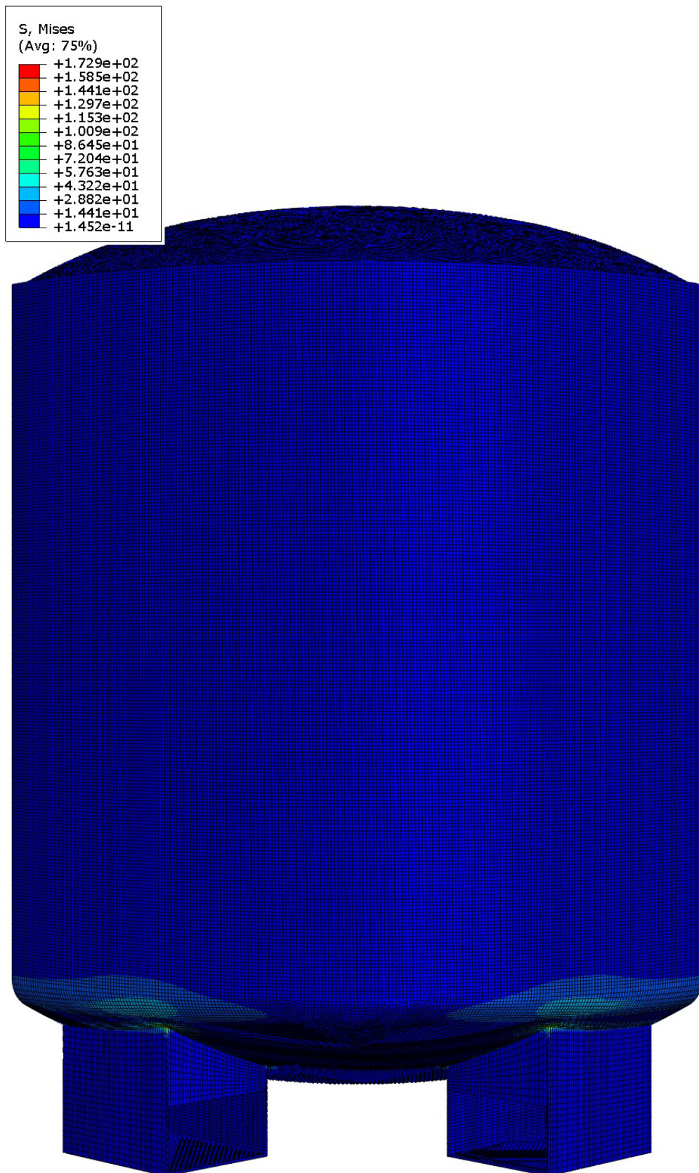
Slika 49. Naprežanje spremnika prema von Misesu
