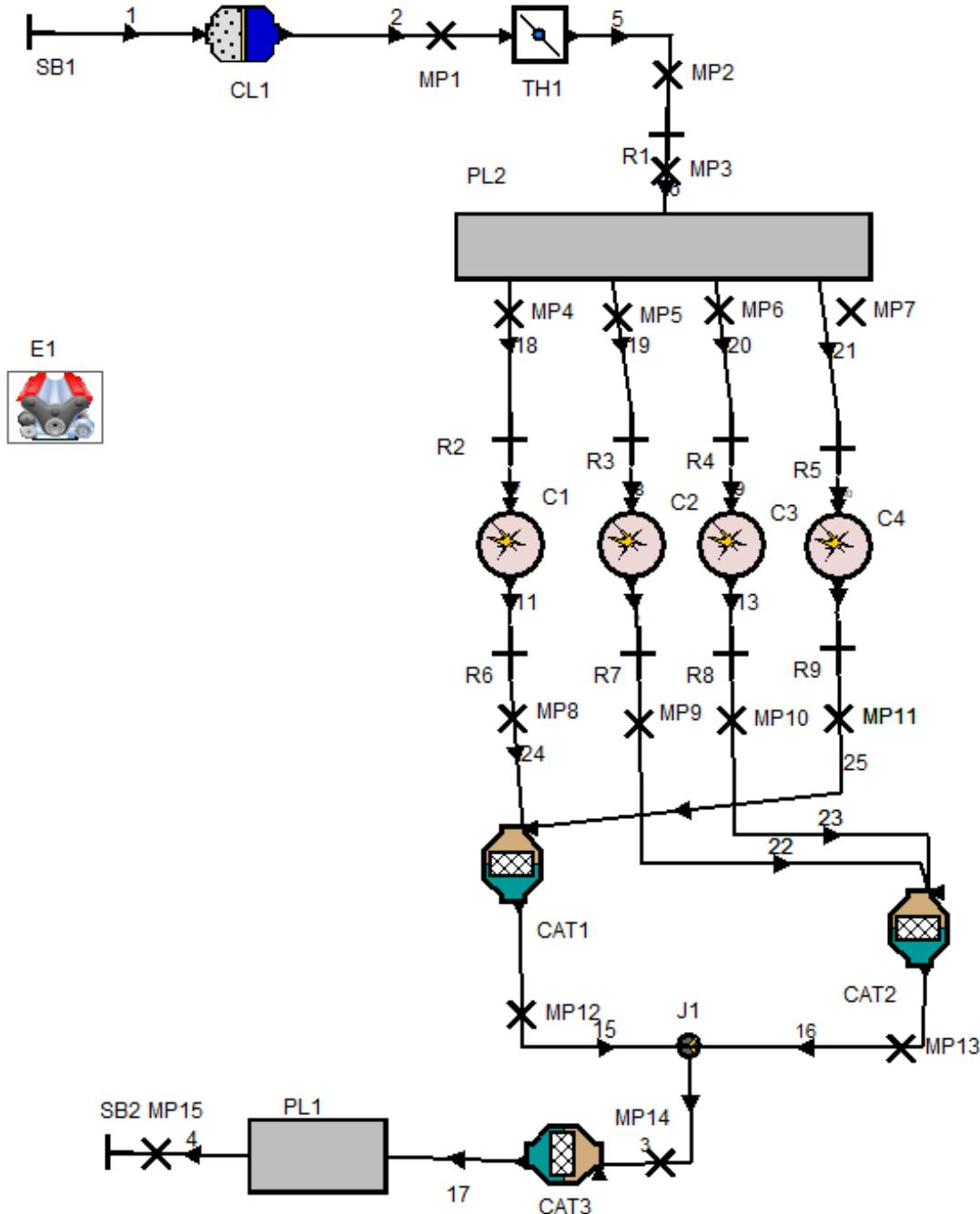
Slika 15. Simulacijski model u programskom paketu AVL BOOST™
