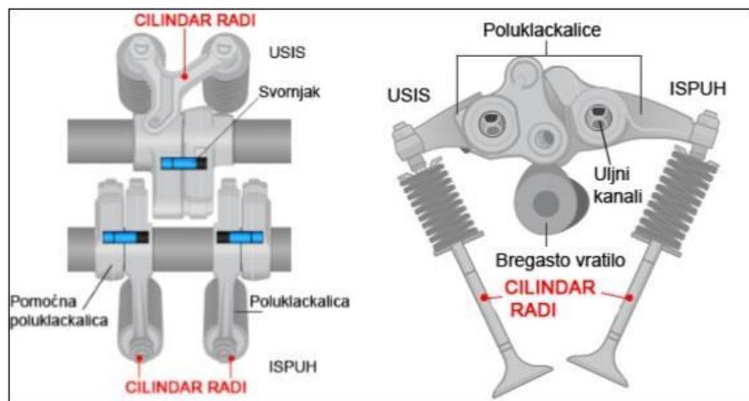
**Slika 2. Sustav pomičnih poluklackalica s jednim bregastim vratilom za slučaj uključenih cilindara [2]**
