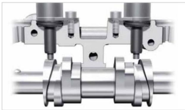
Slika 6. Sustav s pomičnim brijegom bregastog vratila [4]
