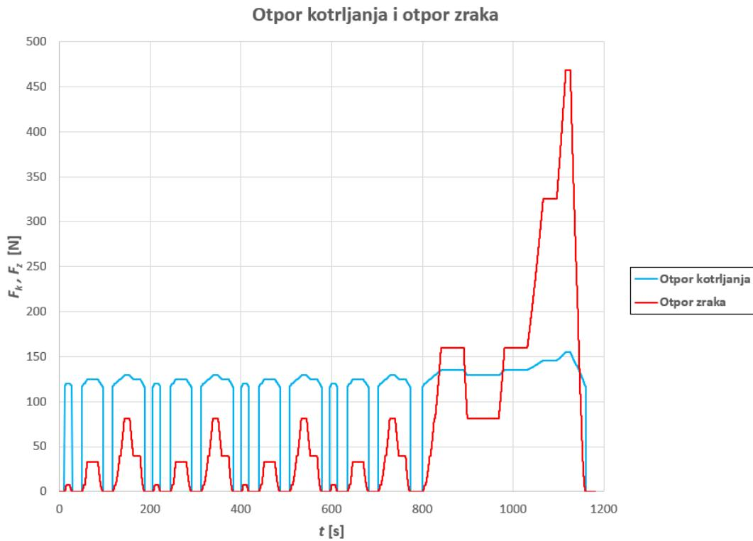
**Slika 32. Prikaz otpora kotrljanja i otpora zraka**
