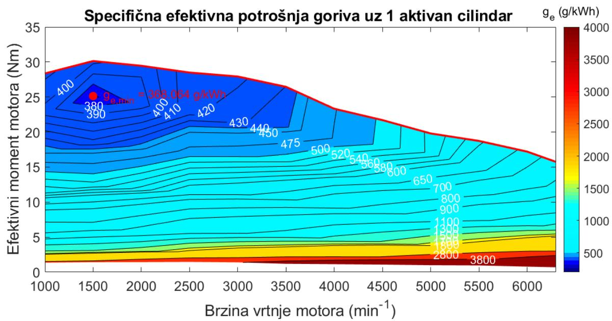
Slika 27. Dijagram specifične efektivne potrošnje goriva uz 1 aktivni cilindar
