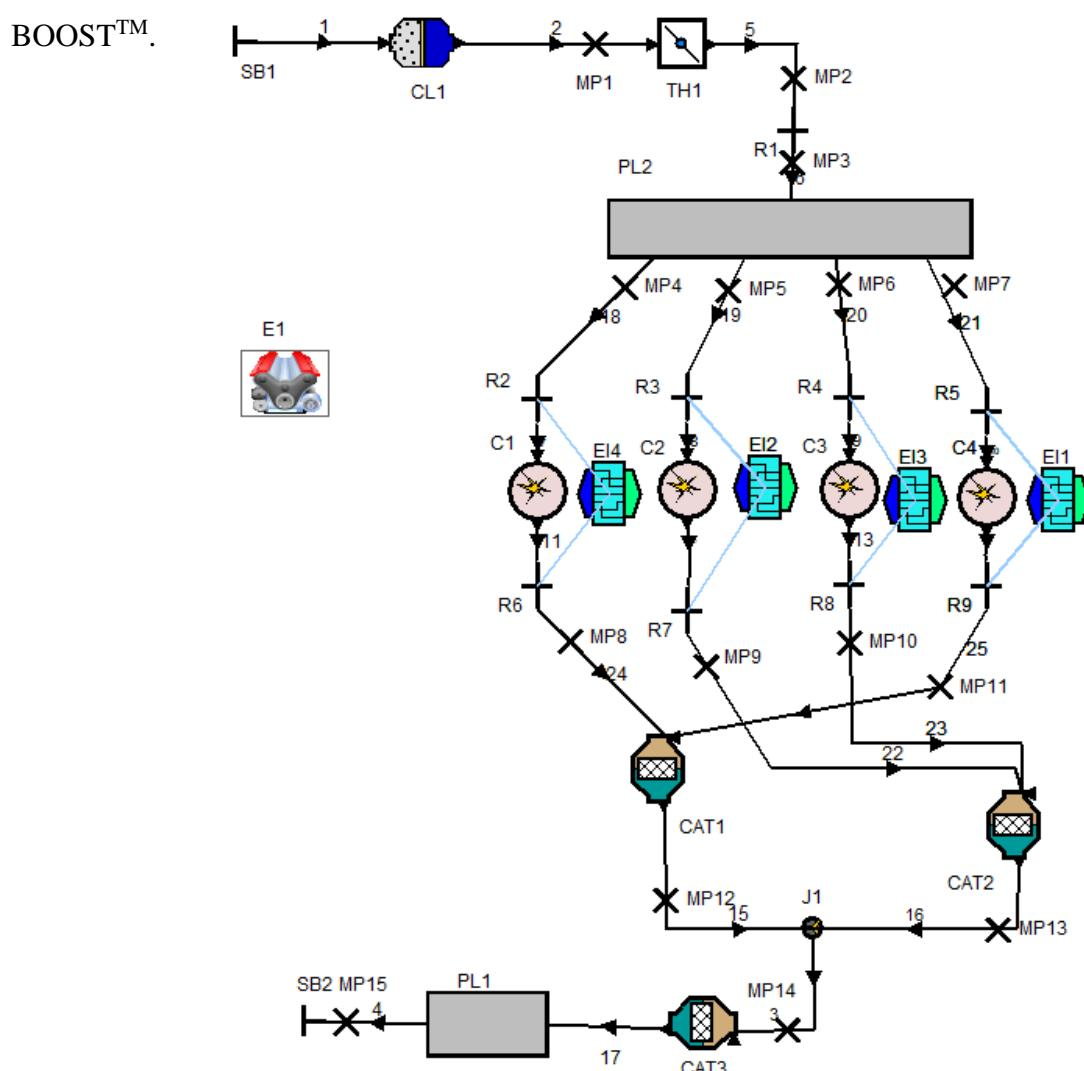
Slika 21. Modificirani simulacijski model s mogućnošću gašenja pojedinog cilindra u programskom paketu AVL BOOST™
