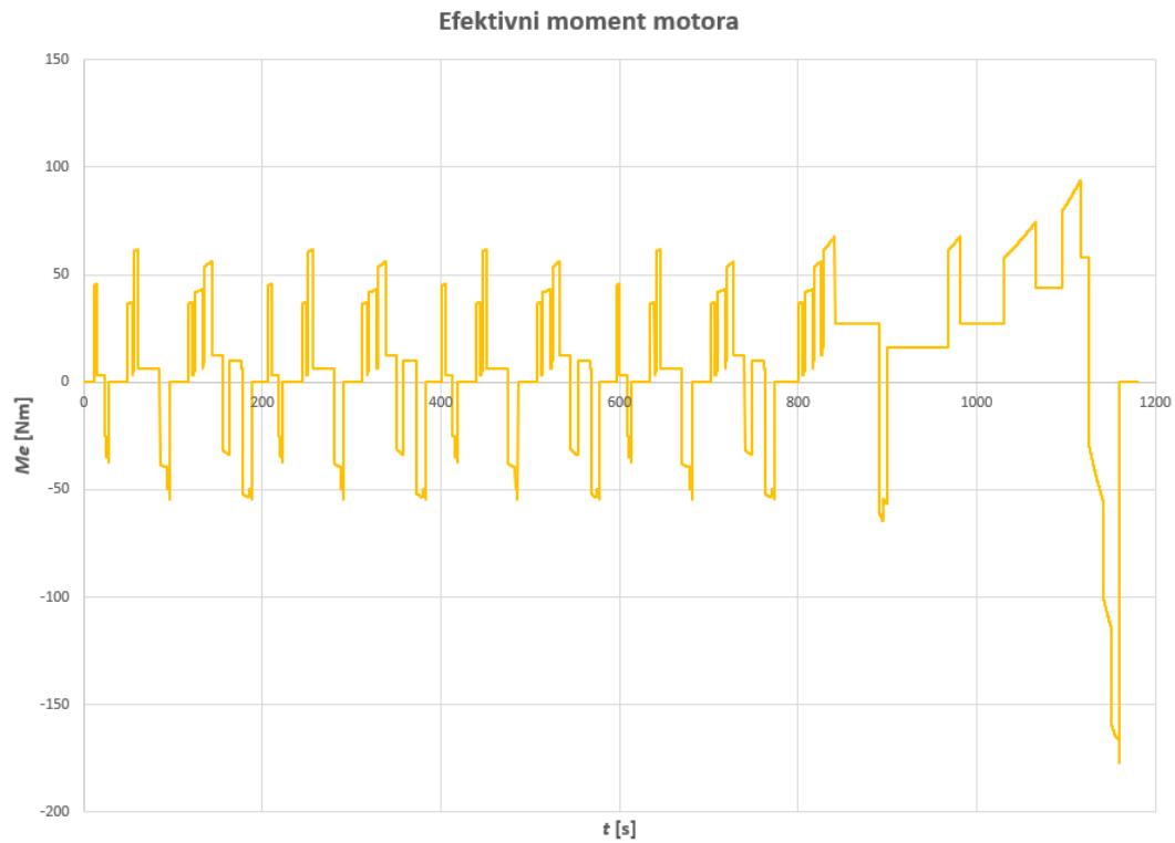
**Slika 34. Prikaz ovisnosti efektivnog momenta o vremenu**
