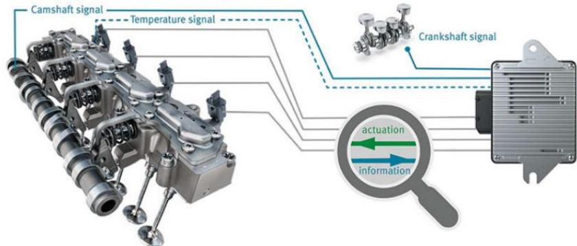
Slika 7. Sustav isključivanja ventila pomoću UniAir [5]
