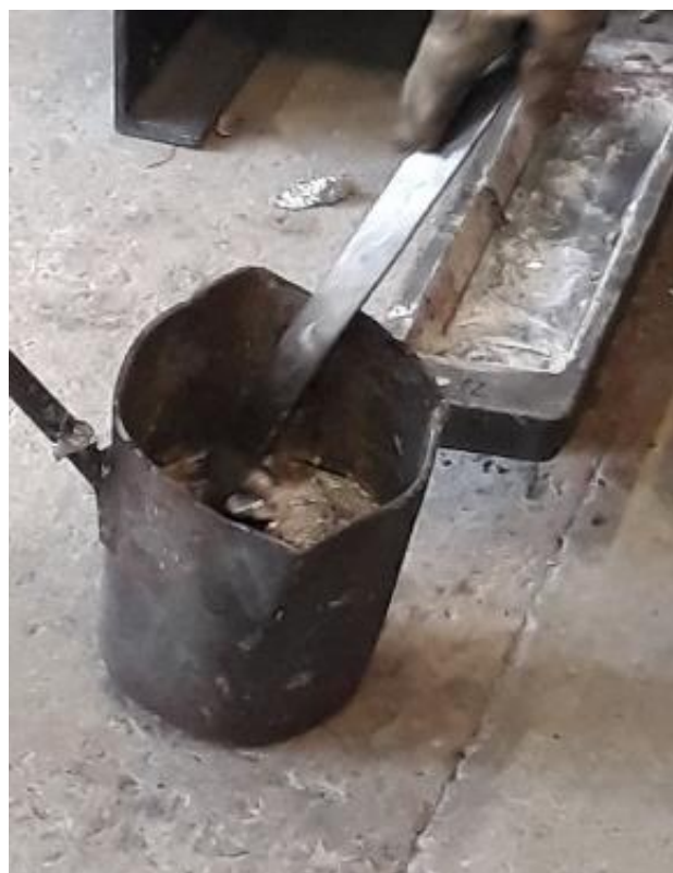
Slika 49. Čišćenje aluminijskih oksida sa površine taljevine.
