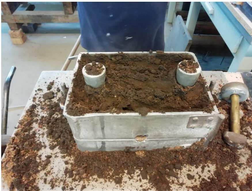
Slika 42. Stavljanje punidbene kalupne mješavine u gornjak.
