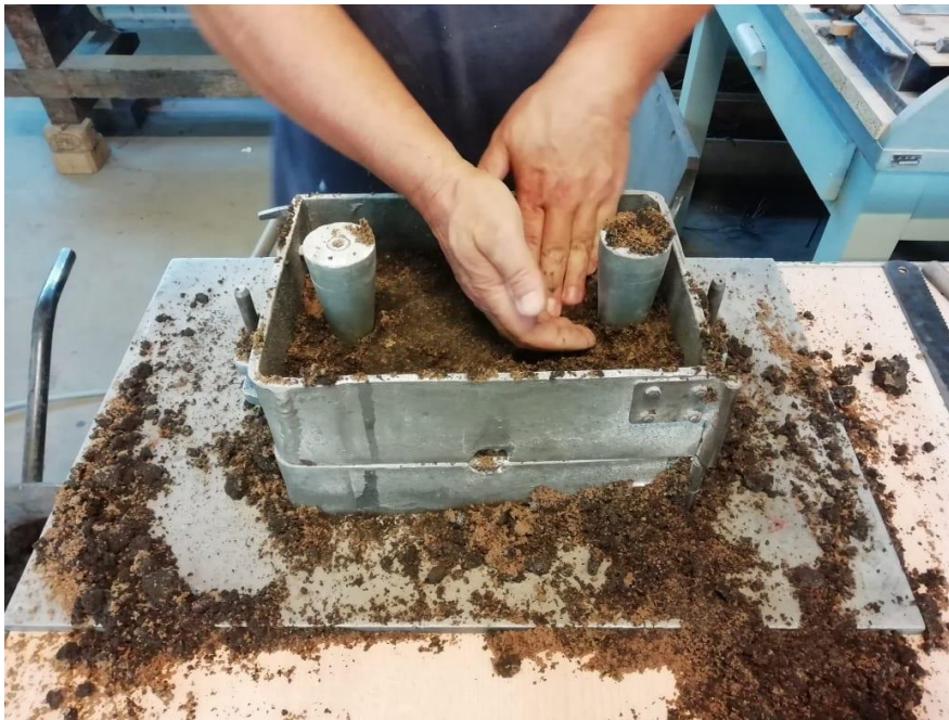
Slika 41. Stavljanje modelne kalupne mješavine u gornjak.
