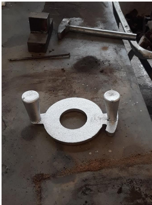
Slika 52. Odljevak s uljevnim sustavom i pojilom.
