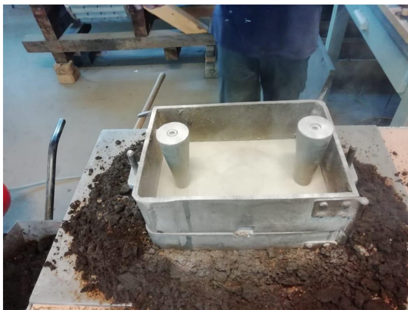
Slika 40. Postavljanje gornjaka na donjak, stavljanje sredstva za razdvajanje te pozicioniranje spusta i pojila u gornjaku.
