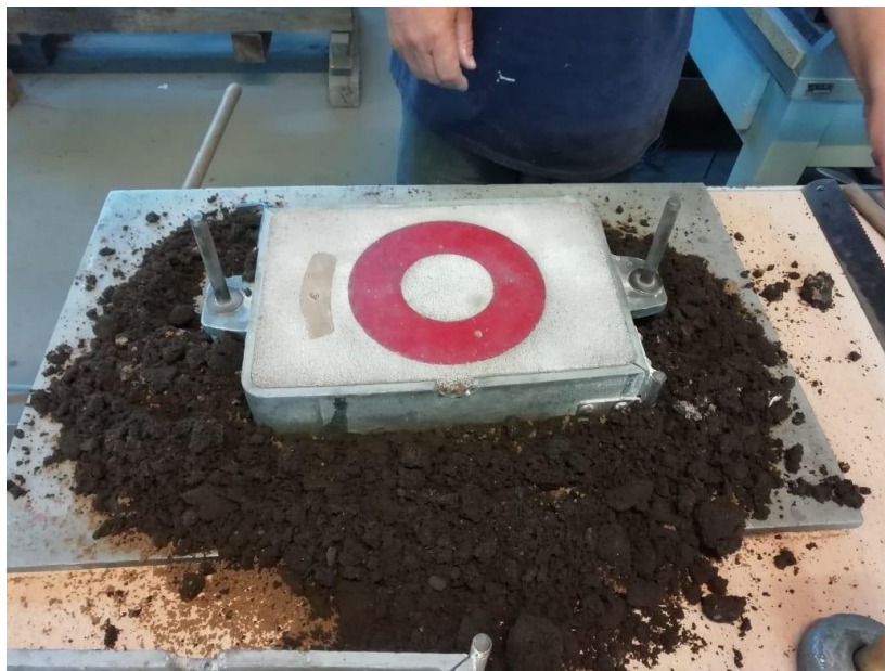
Slika 39. Model diska i razvodnika u donjaku.
