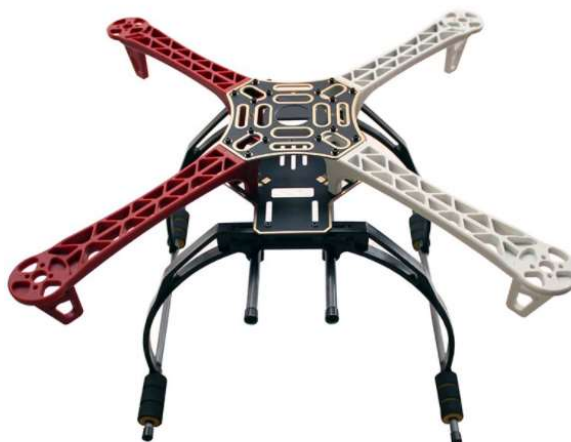
Slika 5.1 DJI F450 konstrukcija s nogama za slijetanje
