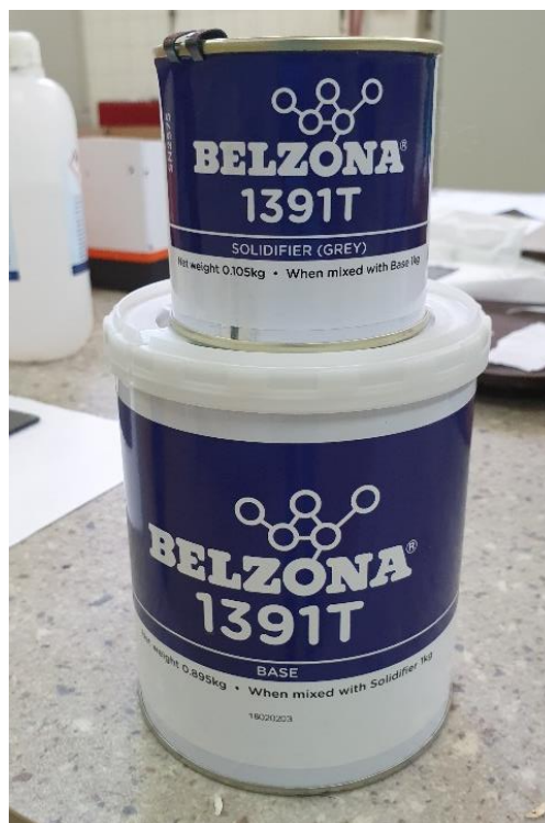
Slika 7.9. Belzona 1391T, keramički ojačan epoksidni premaz
