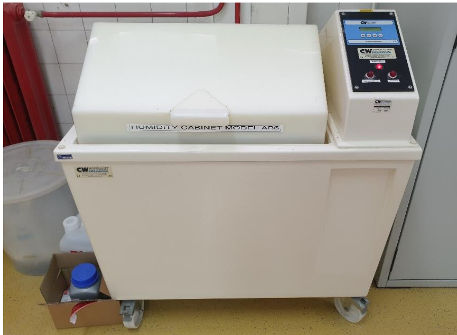
Slika 7.42. Vlažna komora C&W, Model AB6
