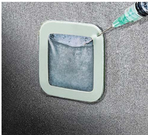
Slika 5.5. Izvođenje Bresle testa
