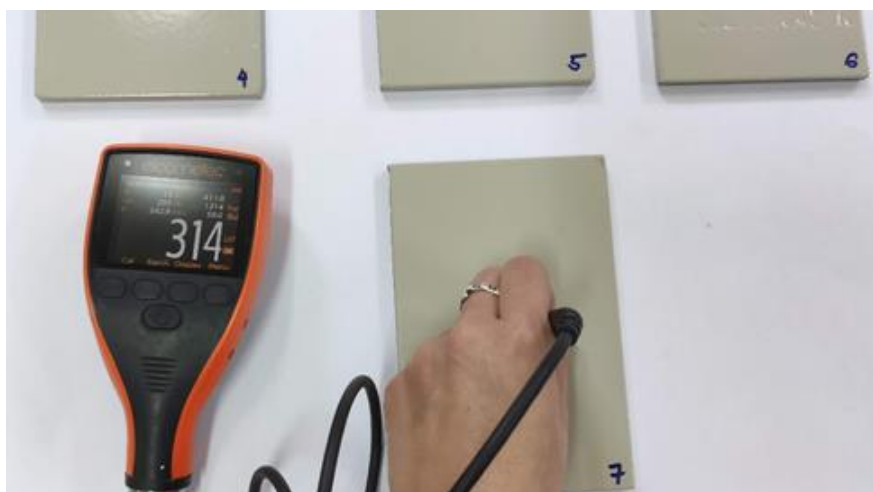
Slika 5.23. Mjerenje DSF-a uređajem Elcometer 456
