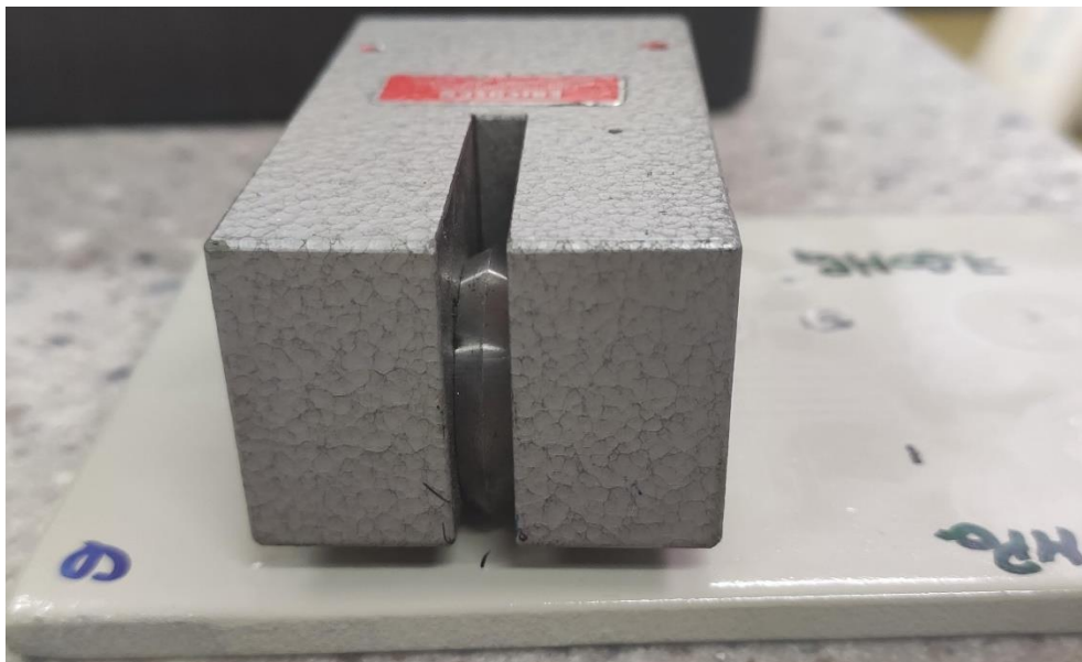
Slika 5.36. Postavljanje utega na uzorak
