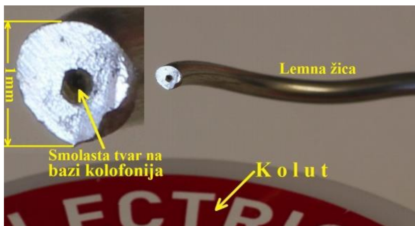
Slika 40. Lemna žica u sredini sa smolastom tvari na bazi kolofonija [38]
