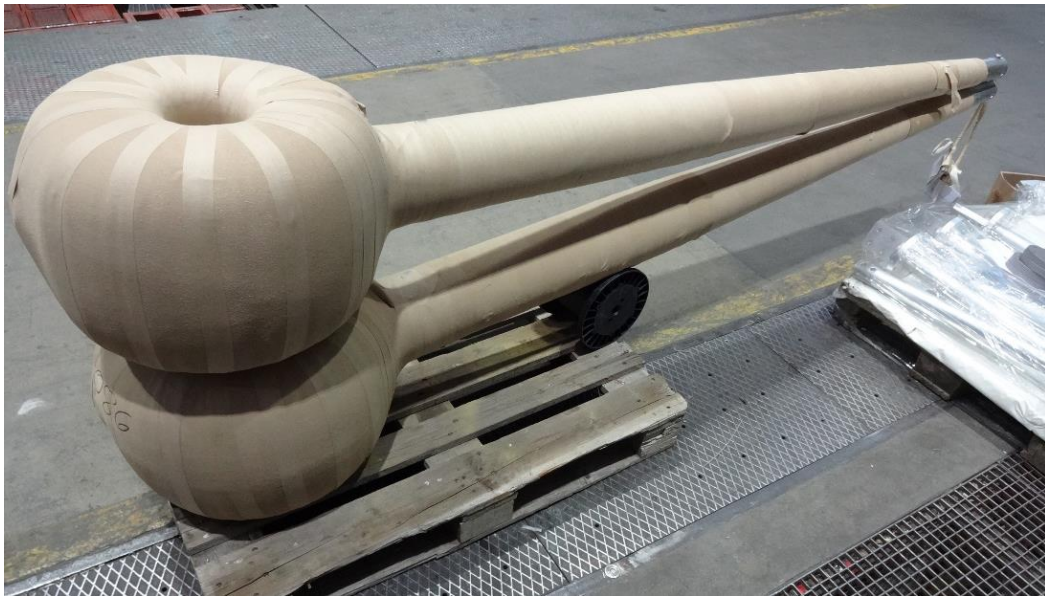
Slika 1.4. Primjer mjernih transformatora spremnih za vakuumsko sušenje
