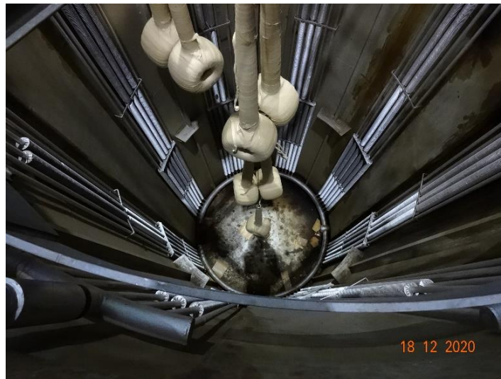
Slika 4.1. Pogled u praznu vakuumsku komoru
