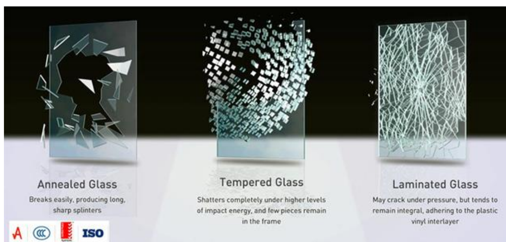
Slika 18. Usporedba različitih tipova stakla uslijed pucanja
