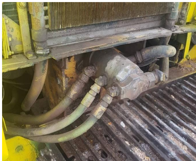
Slika 3.6. Pumpa tvrtke Webster postavljena na stroj
