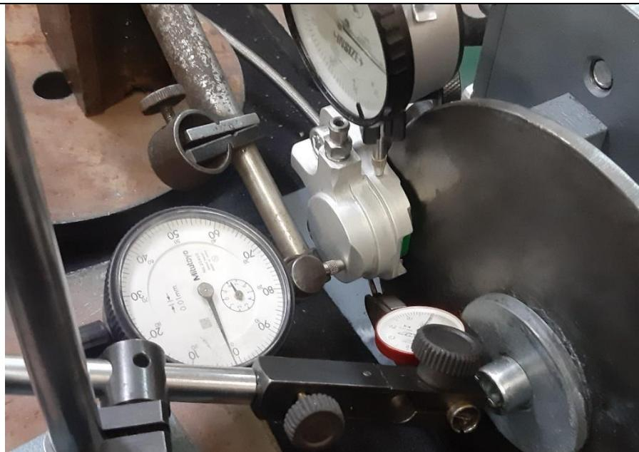
**Slika 36. Mjerenje točke T2 na čeljusti stražnjih kočnica**
