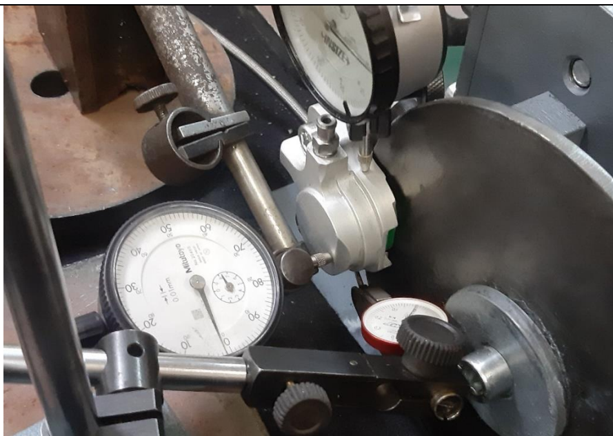
Slika 36. Mjerenje točke T2 na čeljusti stražnjih kočnica
