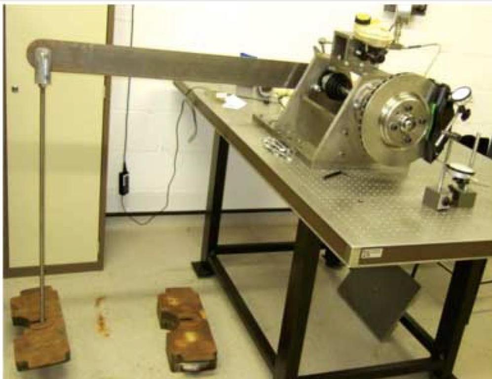
Slika 3. Naprava za mjernje pomaka [1]
