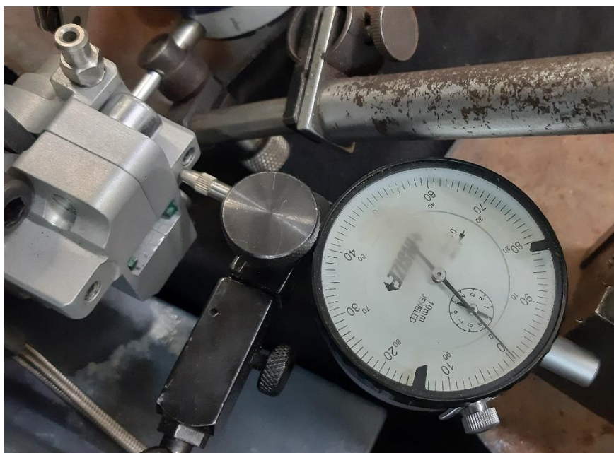
Slika 37. Mjerenje točke T5 na čeljusti stražnjih kočnica
