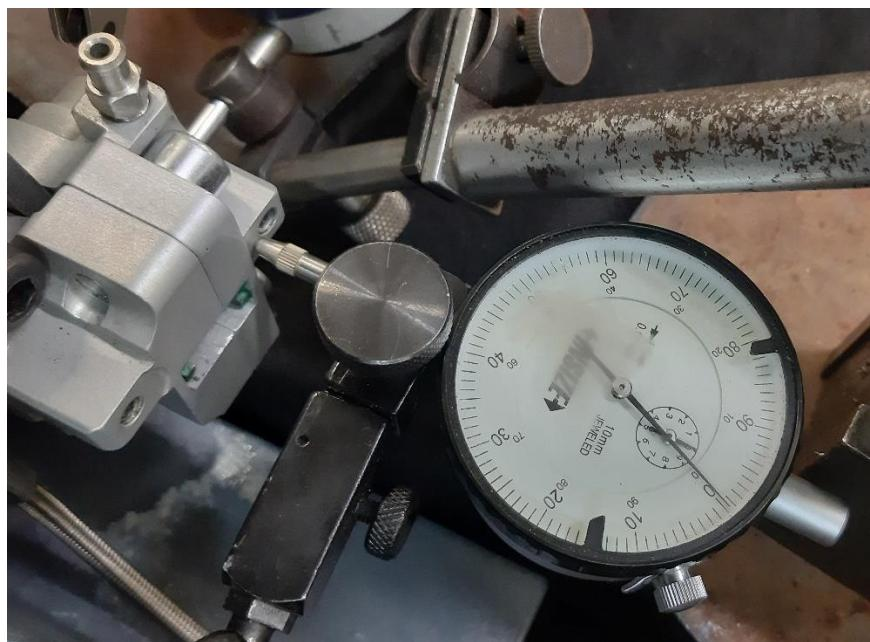
**Slika 37. Mjerenje točke T5 na čeljusti stražnjih kočnica**
