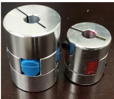
Slika 28. Usporedba nove i stare spojke
