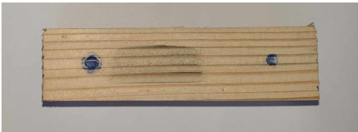
Slika 32. Otisci na uzorku nakon mjerenja tvrdoće
