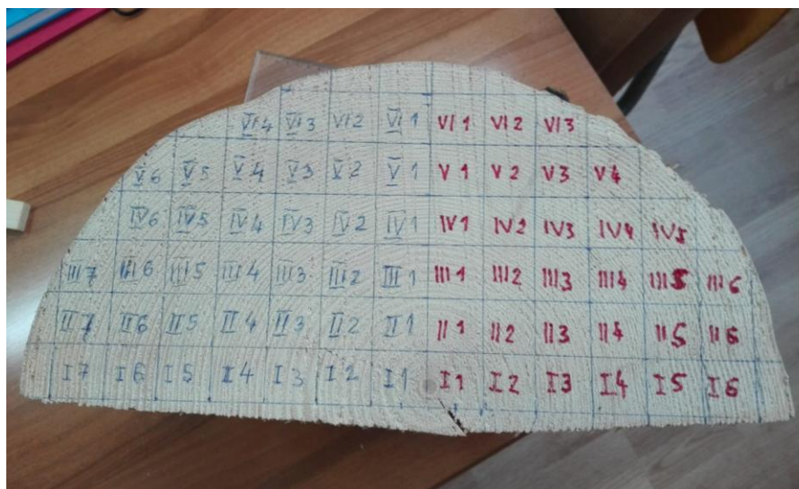
Slika 24. Raspored uzoraka na poprečnom presjeku debla
