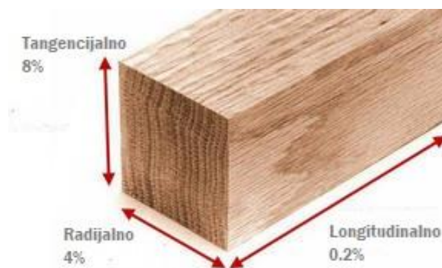
Slika 10. Utjecaj vlage na bubrenje u karakterističnim osima drva [10]
