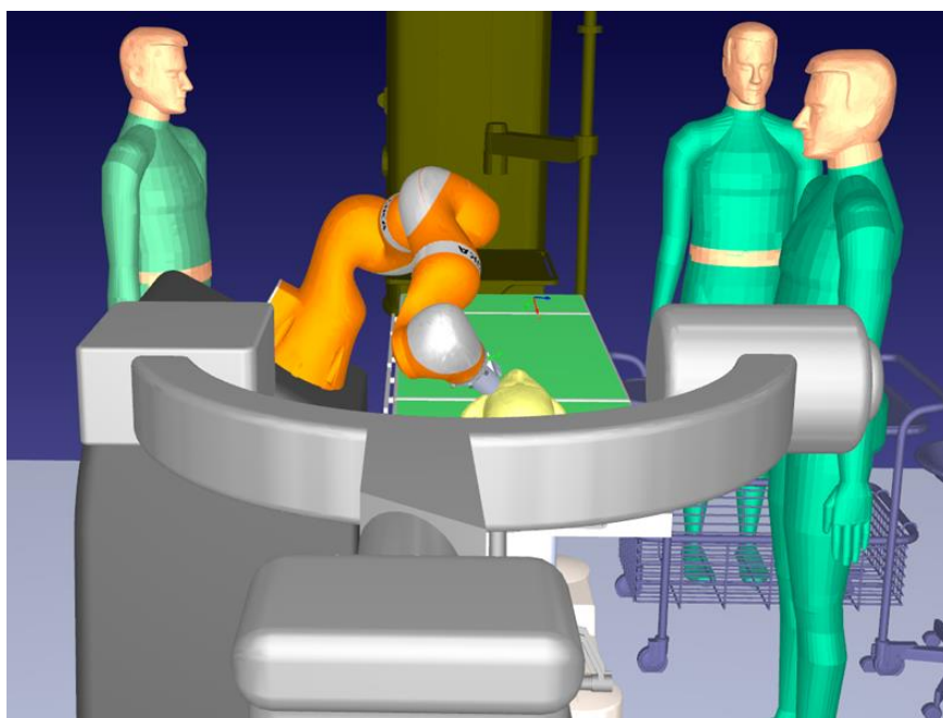
Slika 21. Ispravna pozicija robota u točki operacije
