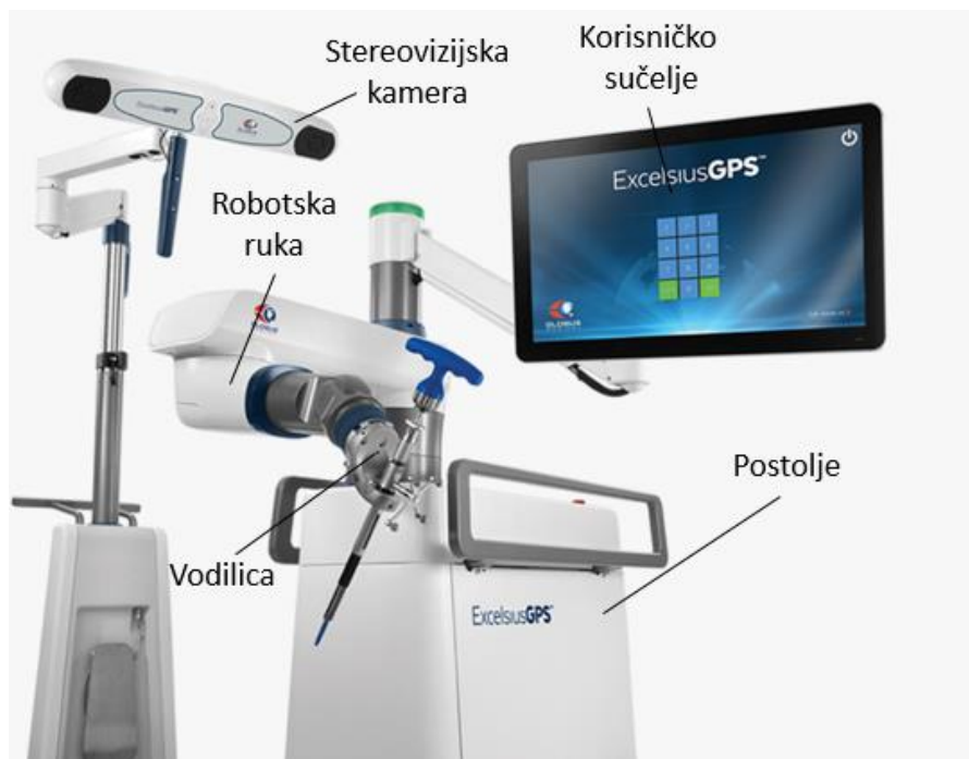
Slika 11. Excelsius GPS robotski sustav[13]
