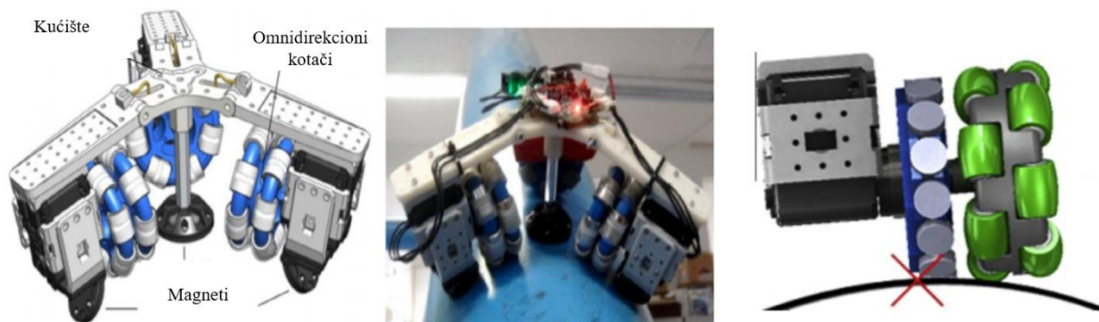
Slika 9. Omnclimber četvrte generacije: sklop (lijevo), adhezija na stupu (sredina), problem naginjanja (desno) [12]
