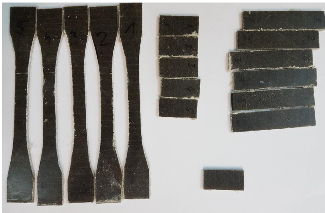
Slika 16. Uzorci za ispitivanje mehaničkih svojstava: lijevo je uzorak za rastezna svojstva, u sredini za prividnu smičnu međuslojnu čvrstoću i desno za savojna svojstva.
