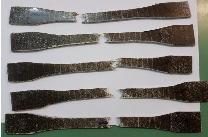
Slika 27. Uzorci ispitani statičkim rasteznim pokusom
