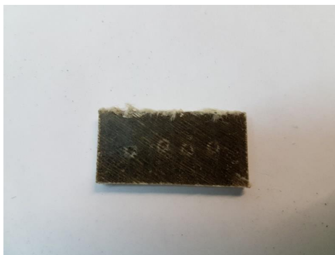
Slika 17. Ispitna pločica nakon provedenog ispitivanja tvrdoće
