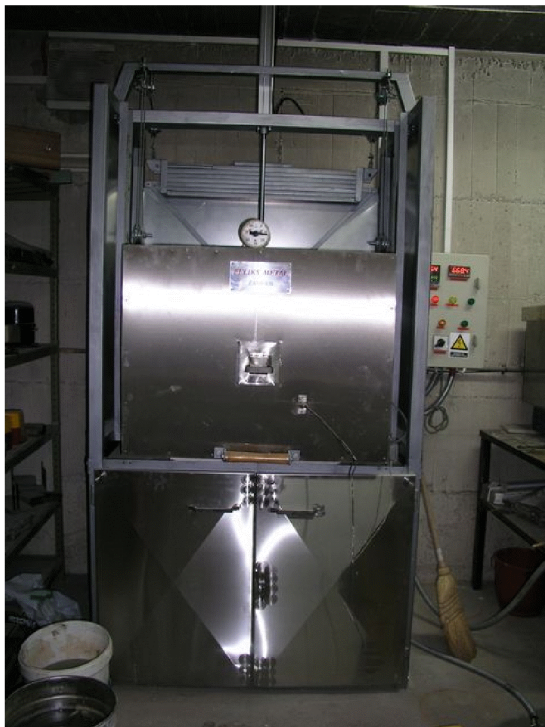
Slika 6.1. Izgled korištene elektrootporne peći
