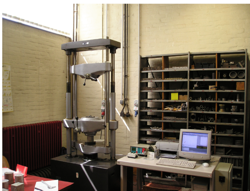
Slika 6.13. Kidalica za statičko tlačno ispitivanje.
