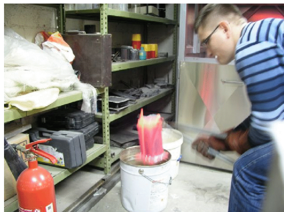
Slika 6.9. Prikaz gašenja kalupa u vodi.
