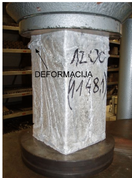
Slika 6.15. Nastanak pukotine pri naprezanju uvijek započinje u sloju najmanje gustoće.
