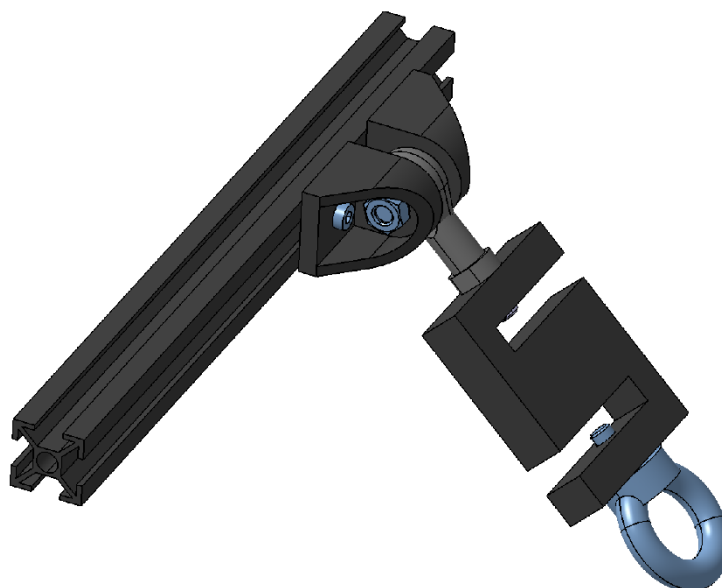
Slika 5.16. Sklop za mjerenje sile u sajli
