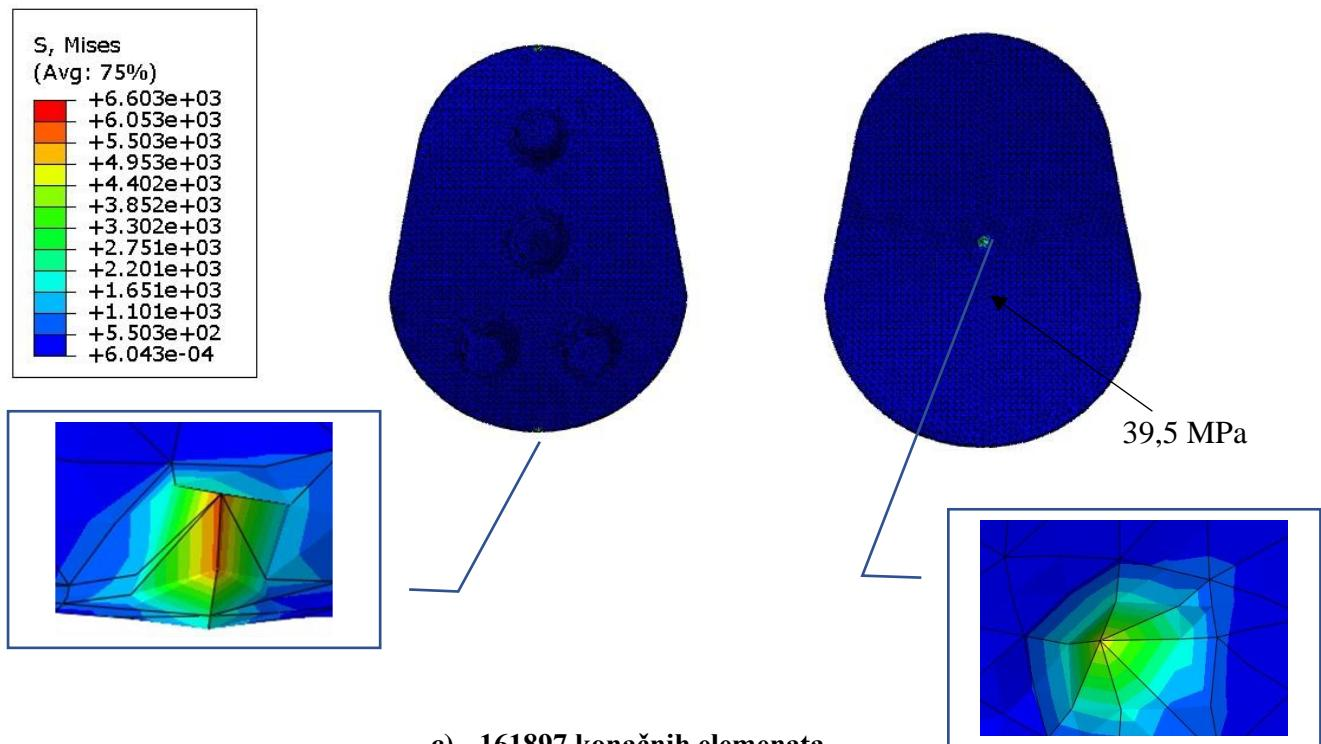
**Slika 44. Raspodjela naprezanja implantata B prema Von Misesu u MPa - Proračunski model 1**
