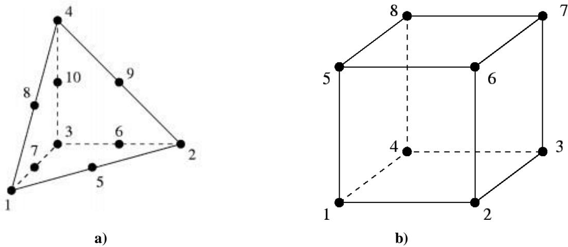
**Slika 20. a) Element C3D10; b) Element C3D8 [11]**
