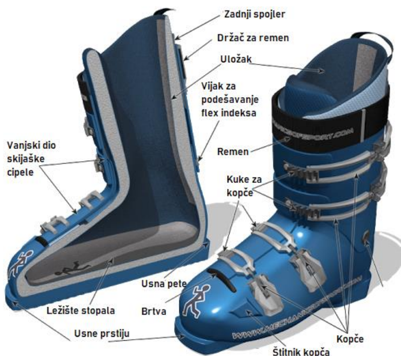
Slika 2.22. Dijelovi skijaške cipele [37]
