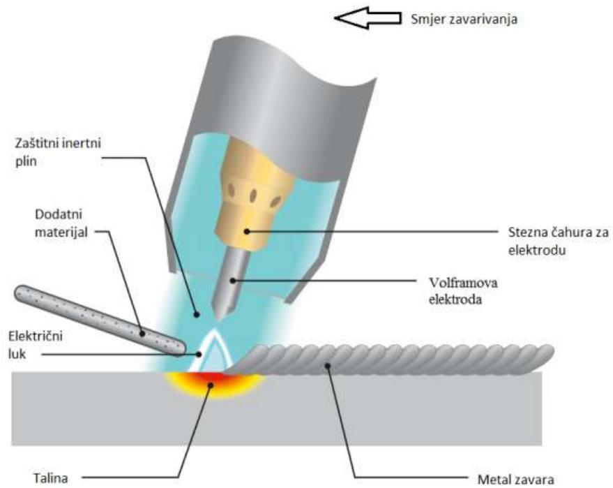
Slika 5. Shematski prikaz procesa TIG zavarivanja [9]
