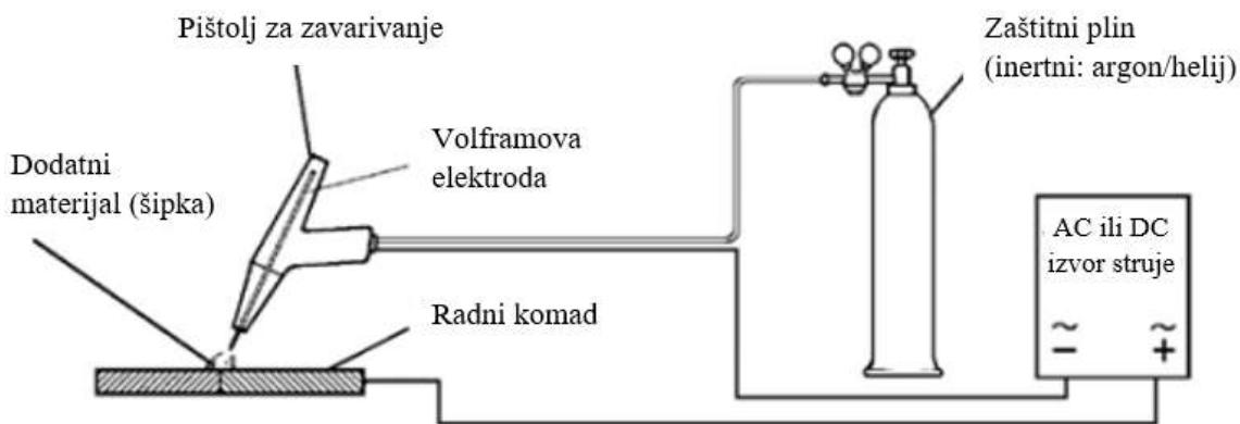
Slika 4. Pojednostavljeni shematski prikaz TIG postupka zavarivanja [6]
