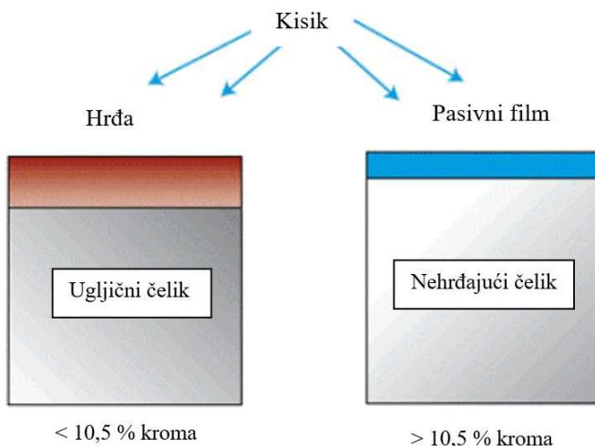
Slika 1. Ugljični čelik i nehrđajući čelik u doticaju s kiskom [4]
