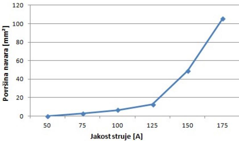
Slika 28. Grafički prikaz ovisnosti površine poprečnog presjeka navara o jačini struje
