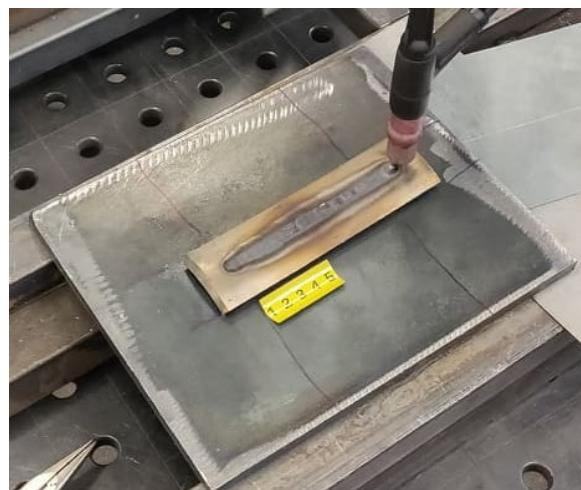
Slika 13. Izgled uzorka neposredno nakon navarivanja
