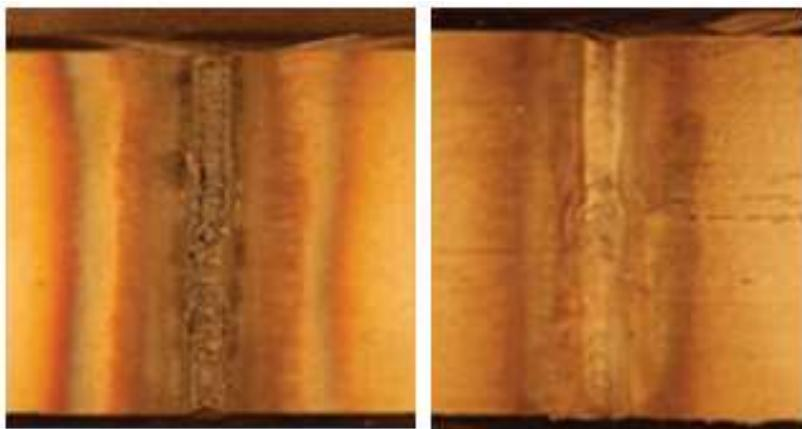
Slika 8. Korijenska strana zavara bez korijenske zaštite (lijevo) i sa korijenskom zaštitom plinskom mješavinom  $N_2+10\% H_2$  (desno) [18]
