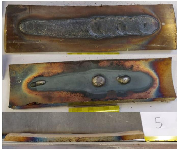
Slika 19. Uzorak 5 ( $I = 175 \text{ A}$ ,  $U = 14,6 \text{ V}$ )
