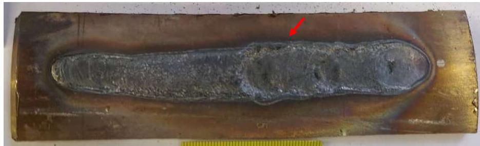
Slika 23. Poroznost na licu navara uzorka 5
