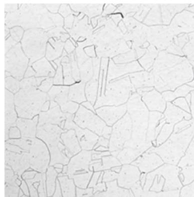
Slika 3. Mikrostruktura austenitnog nehrđajućeg čelika X5CrNi18-10 [3]
