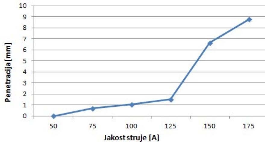
Slika 26. Grafički prikaz ovisnosti penetracije o jačini struje
