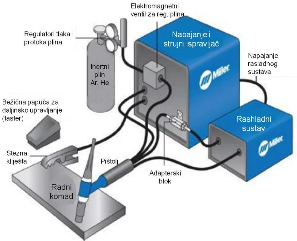
Slika 6. Oprema za TIG zavarivanje [11]
