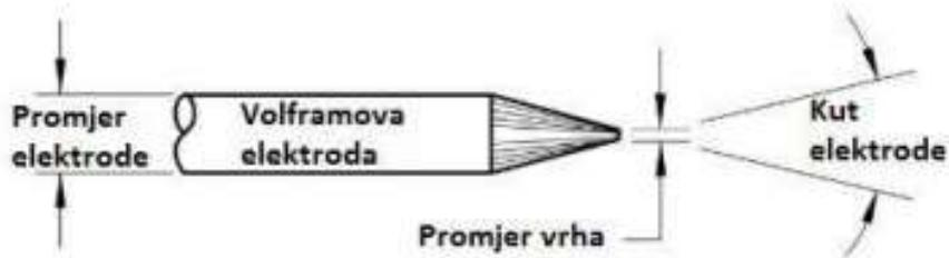
Slika 7. Geometrija elektrode sa šiljastim vrhom [14]
