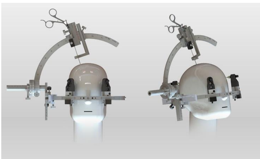
Slika 1. Prikaz instrumenta za biopsiju mozga i okvira [7]
