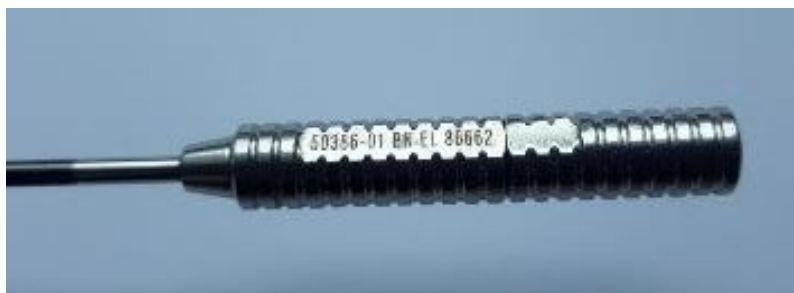
Slika 53. Prikaz brušenih dijelova biopsijske sonde
