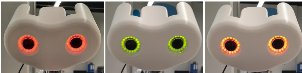
Slika 47. Prikaz crvenog i zelenog osvjetljenja te njihove kombinacije
