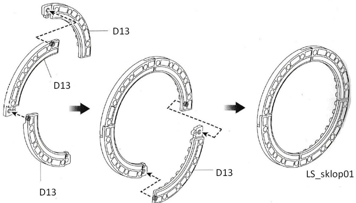
**Slika 29. Montažna operacija za LS\_sklop01 – Stanica 1**
