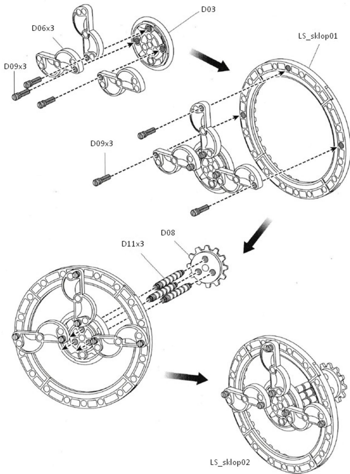
Slika 30. Montažna operacija za LS\_sklop02 – Stanica 2
