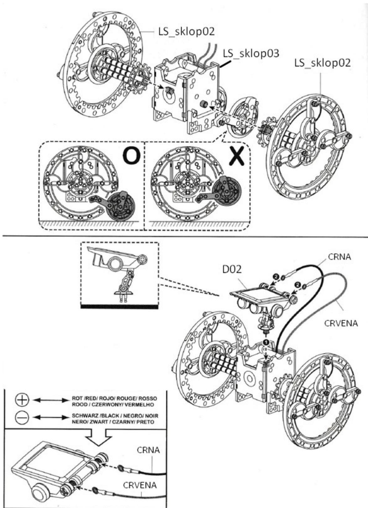
Slika 32. Montažna operacija za LS\_sklop04 – Stanica 4
