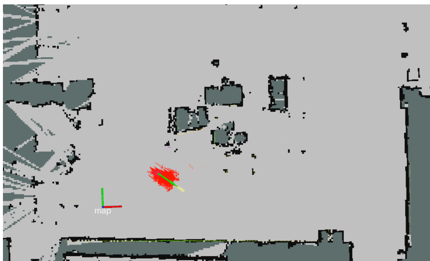
Slika 37. Prikaz zadovoljavajuće konvergencije pozicije i orijentacije robota
