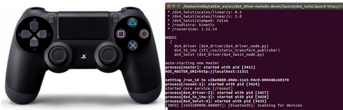
Slika 23. Prikaz Playstation 4 upravljača-lijevo i pokretanje ds4_driver čvora-desno
