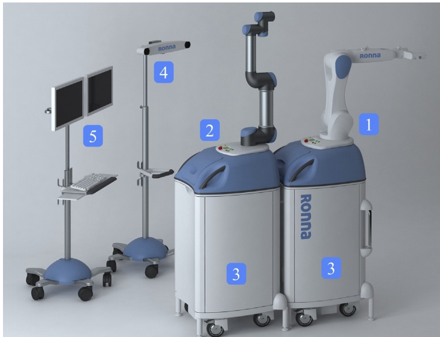
Slika 1.1: Prikaz sustava RONNA G3 s komponentama: (1) glavni robot, (2) pomoćni robot, (3) univerzalna mobilna platforma, (4) optički sustav za praćenje i (5) softversko sučelje za upravljanje i planiranje. [3]
