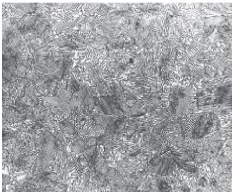
Slika 12. Mikrostruktura C105U visokougličnog čelika [12]
