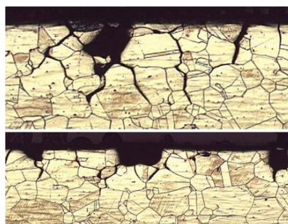
Slika 7. Propagacija korozije duž kristalnih zrna [8]
