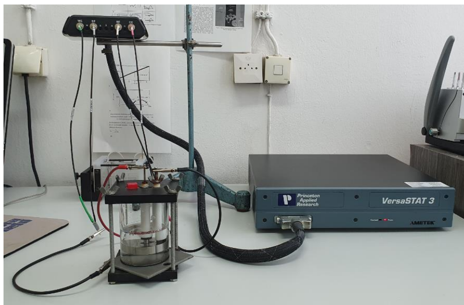
Slika 29. Sustav ispitnog uređaja, ćelije i uzorka
