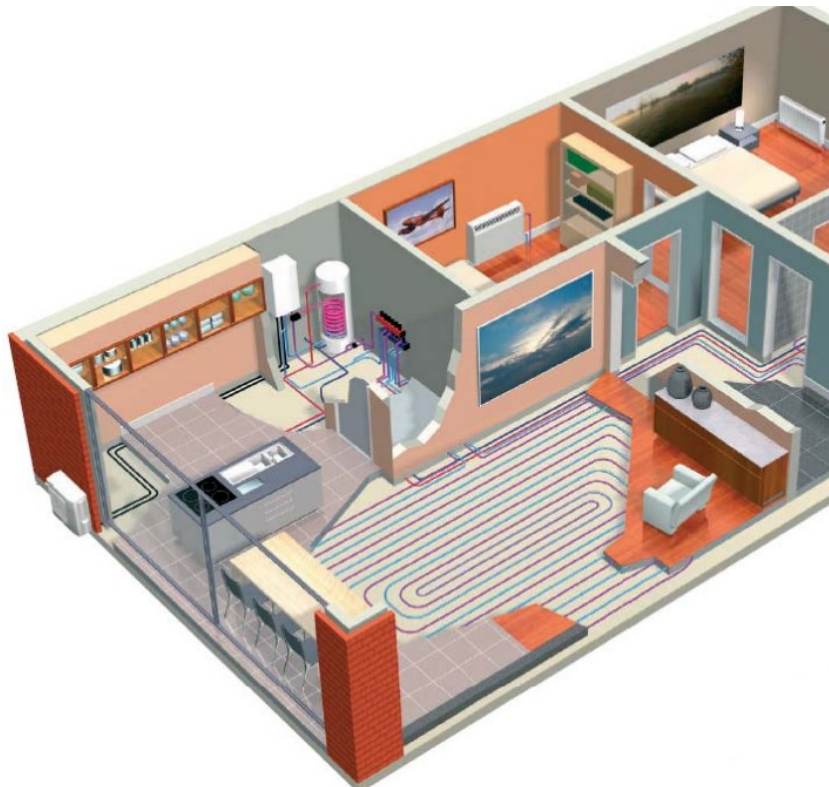
Slika 9. Shematski prikaz sustava zrak-voda dizalice topline [10]
