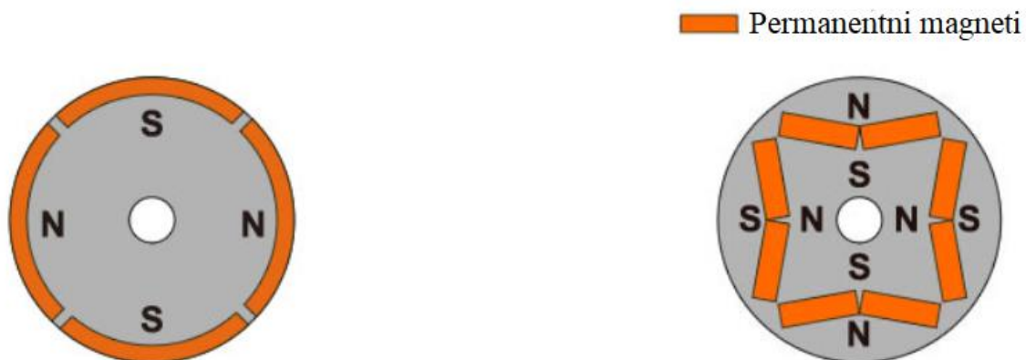
Slika 7. SPM (lijevo) i IPM (desno) [32]
