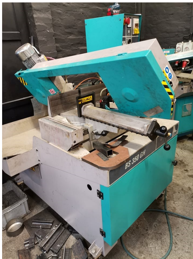
Slika 27. Tračna pila korištena za rezanje zida
