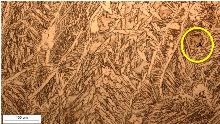
Slika 80. Mikrostruktura prije homogenizacijskog žarenja, povećanje 200x
