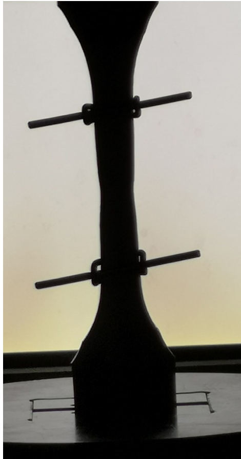
Slika 66. Vidljivo nastajanje vrata na epruveti
