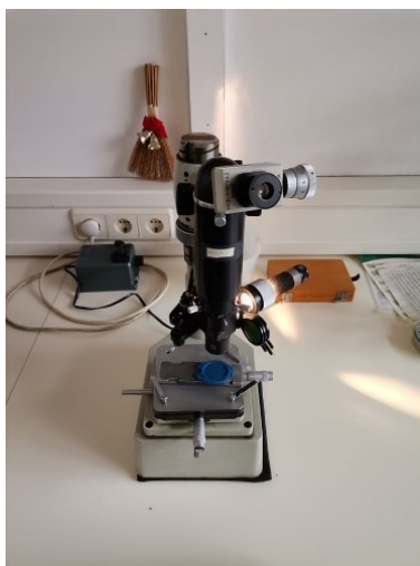
Slika 42. Mikrotvrdomer PMT-3 korišten u eksperimentu
