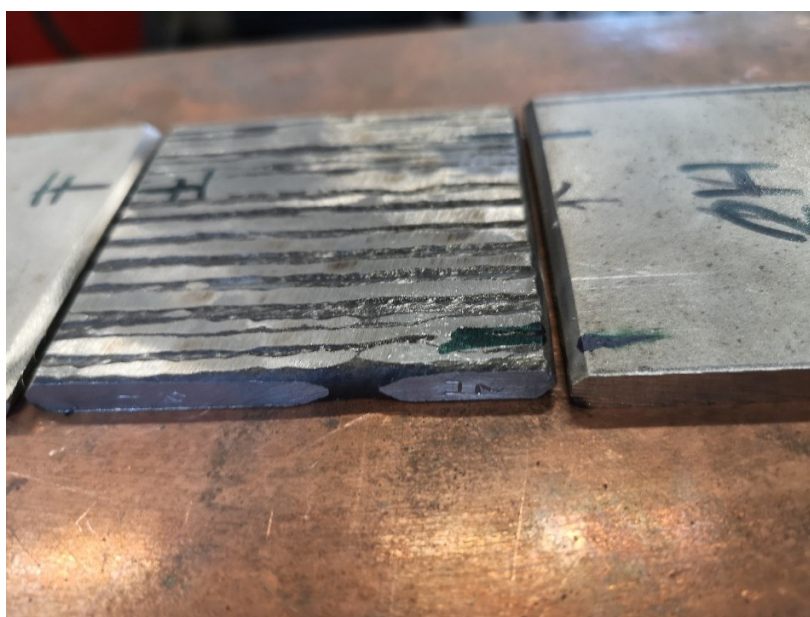
Slika 49. Priprema za navarivanje dodatka okomito na smjer izrade (2H)
