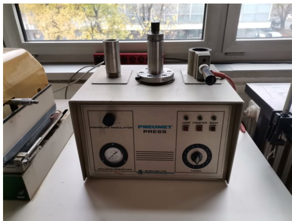
Slika 37. Uređaj za zalijevanje uzoraka u masu
