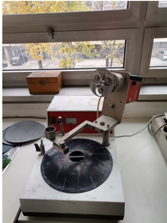
Slika 39. Uređaj za fino poliranje uzoraka
