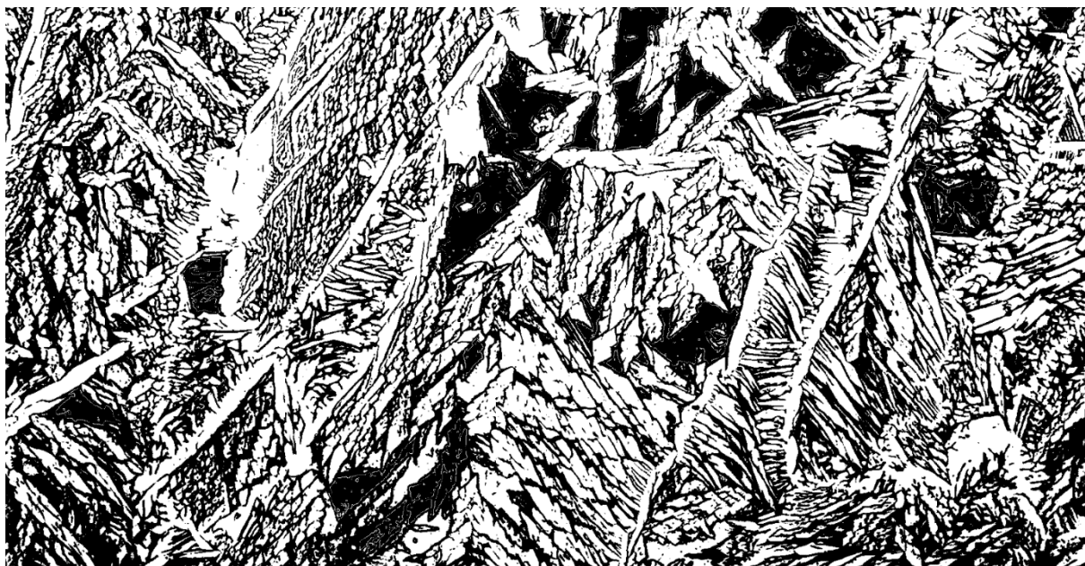
Slika 85. Računalno dorađena slika korištena za izračun udjela ferita, bez toplinske obrade, povećanje 200x (B3)
