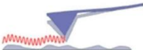
Slika 16. Shematski prikaz rada beskontaktna metode AFM-a [32]
