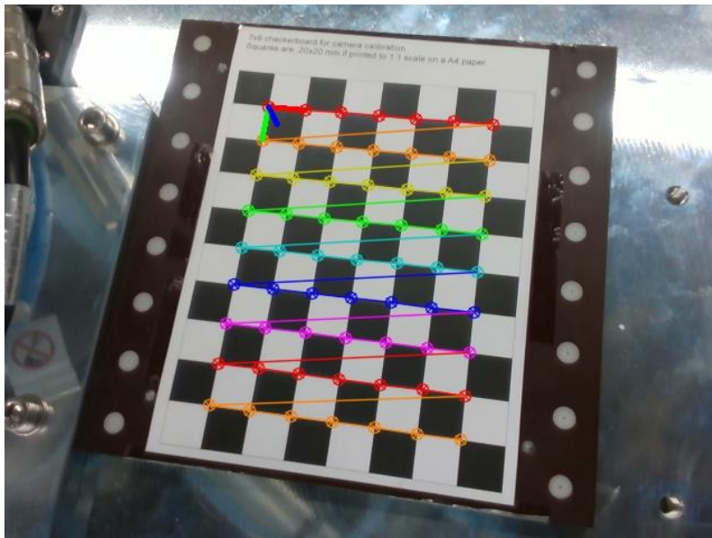
Slika 15. Rekonstrukcija koordinatnog sustava slike šahovnice
