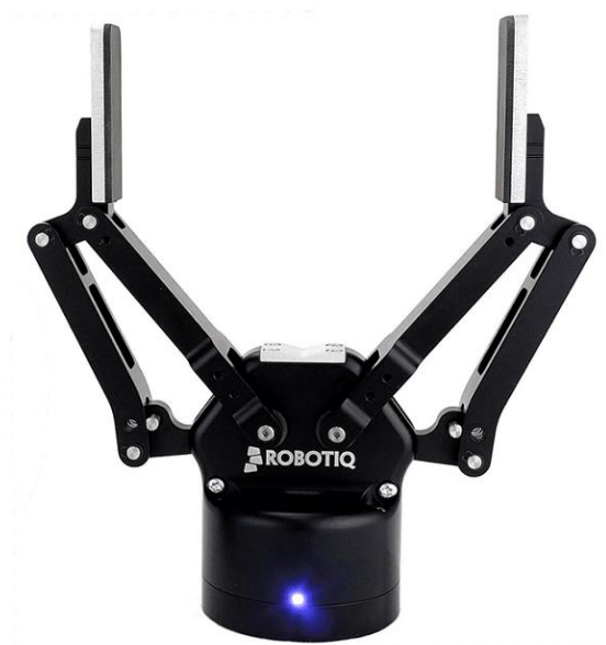
Slika 6. Hvataljka Robotiq 2F-140 [7]
