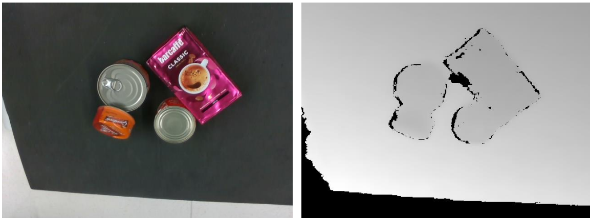
Slika 34. Slika u boji i dubinska slika objekata
