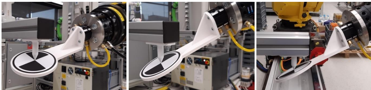
Slika 30. Prikaz postupka kalibracije koordinatnog sustava alata za kalibraciju kamera
