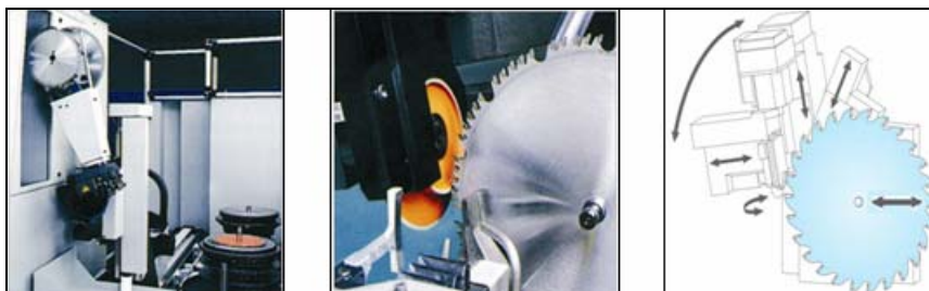
Slika 6.4 (s lijeva na desno) 1. Robotska ruka stavlja pilu u stroj 2. Brušenje leđnog dijela zuba 3. Broj osi stroja.
