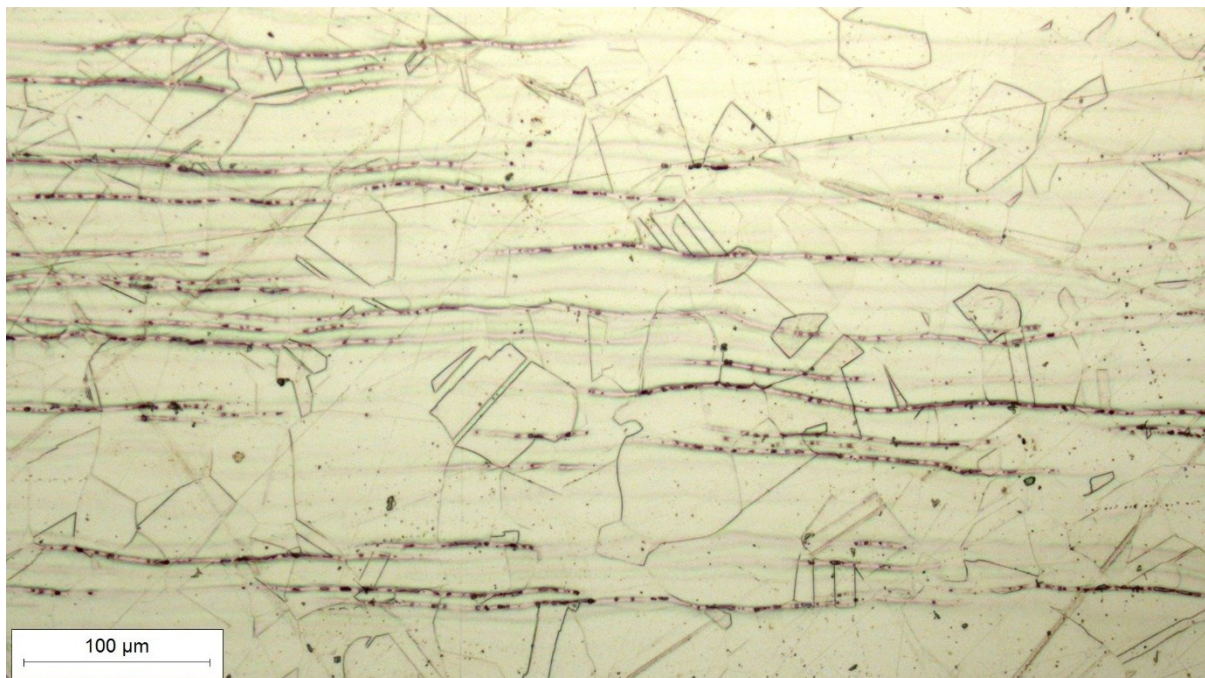
Slika 24. Mikrostruktura srednjeg dijela ploče snimljena pri povećanju 200×
