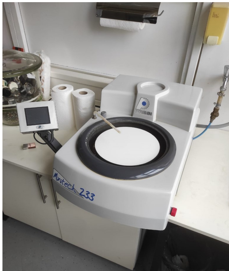
Slika 18. Uređaj za brušenje Presi Minitex 233
