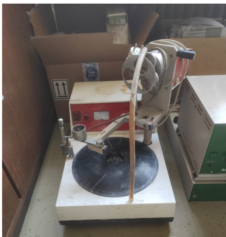
Slika 19. Uređaj Struers DAP-V
