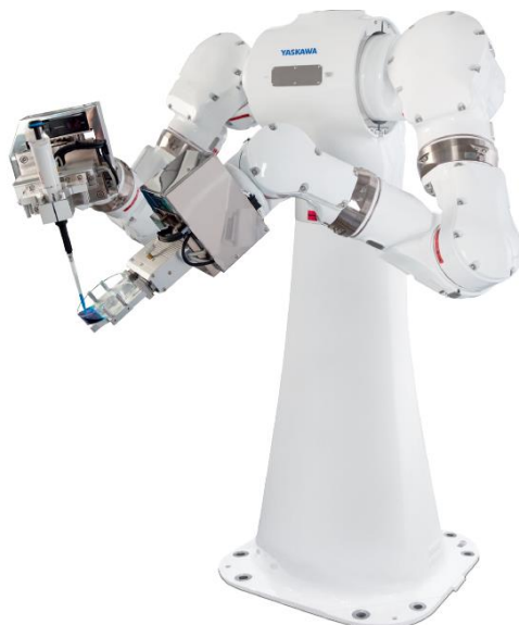
Slika 29. Yaskawa CSDA10F 15-osni manipulator [13]
