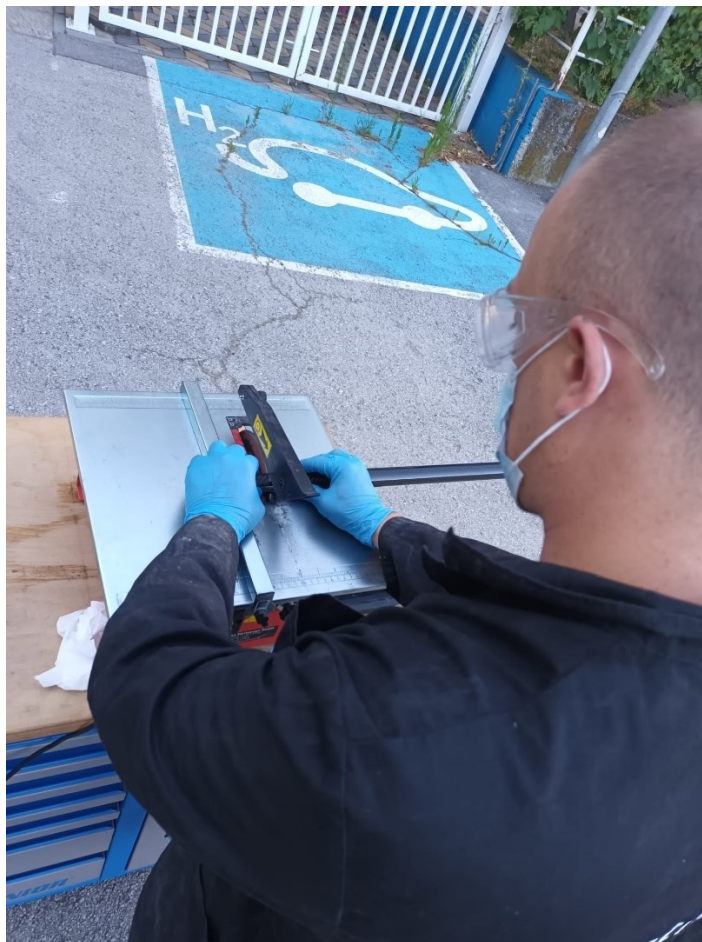
Slika 38. Izrezivanje karbon kompozit cijevi
