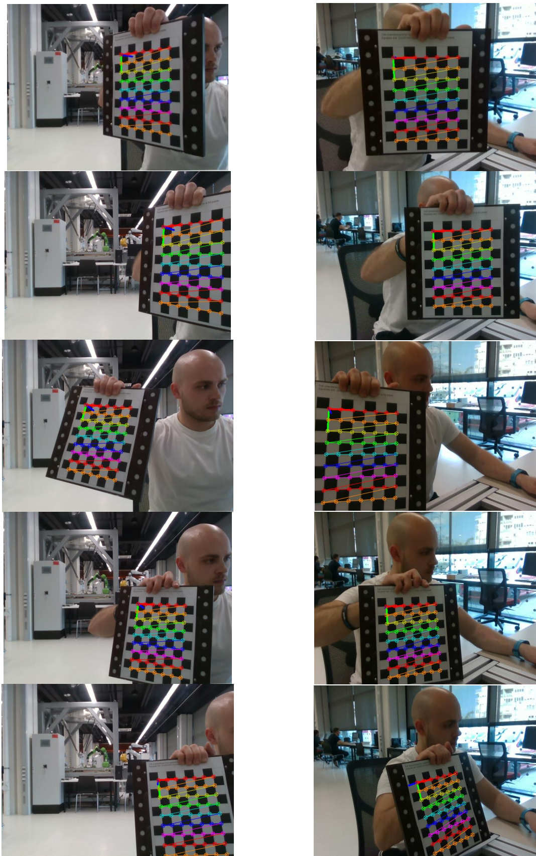
Slika 34. Primjer slika uzetih za stereo kalibraciju
