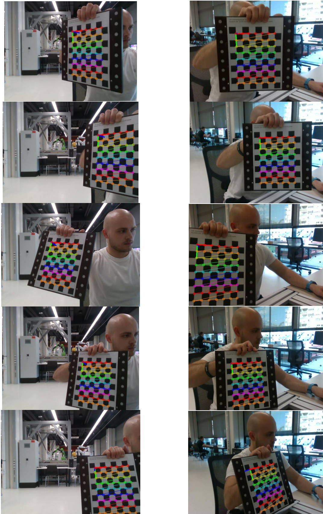
Slika 34. Primjer slika uzetih za stereo kalibraciju
