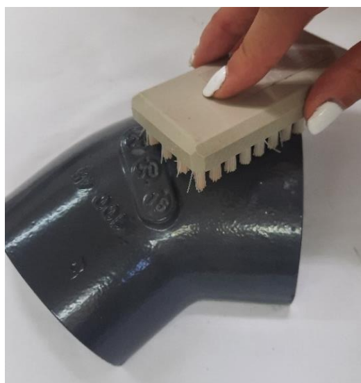
Slika 26. Odstranjivanje čestica četkom
