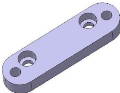
Slika 10. CAD model postolja za spoj velike IGUS vodilice i podloge aluminijskog profila
