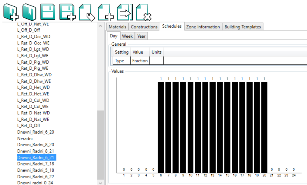
Slika 16. Prikaz definiranja dnevnog rasporeda korištenja u sklopu kartice Schedules
