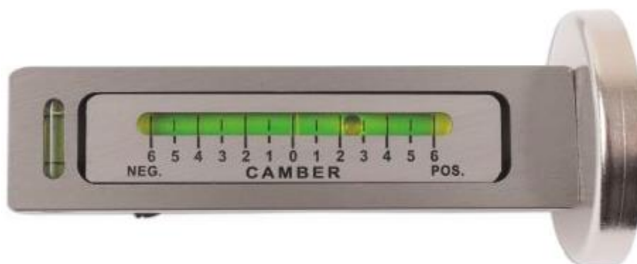
Slika 4.2. Libela za mjerenje bočnog nagiba kotača [8]
