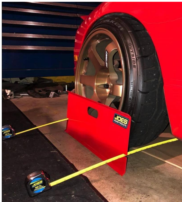
Slika 4.7. Ploče za mjerenje usmjerenosti kotača [12]
