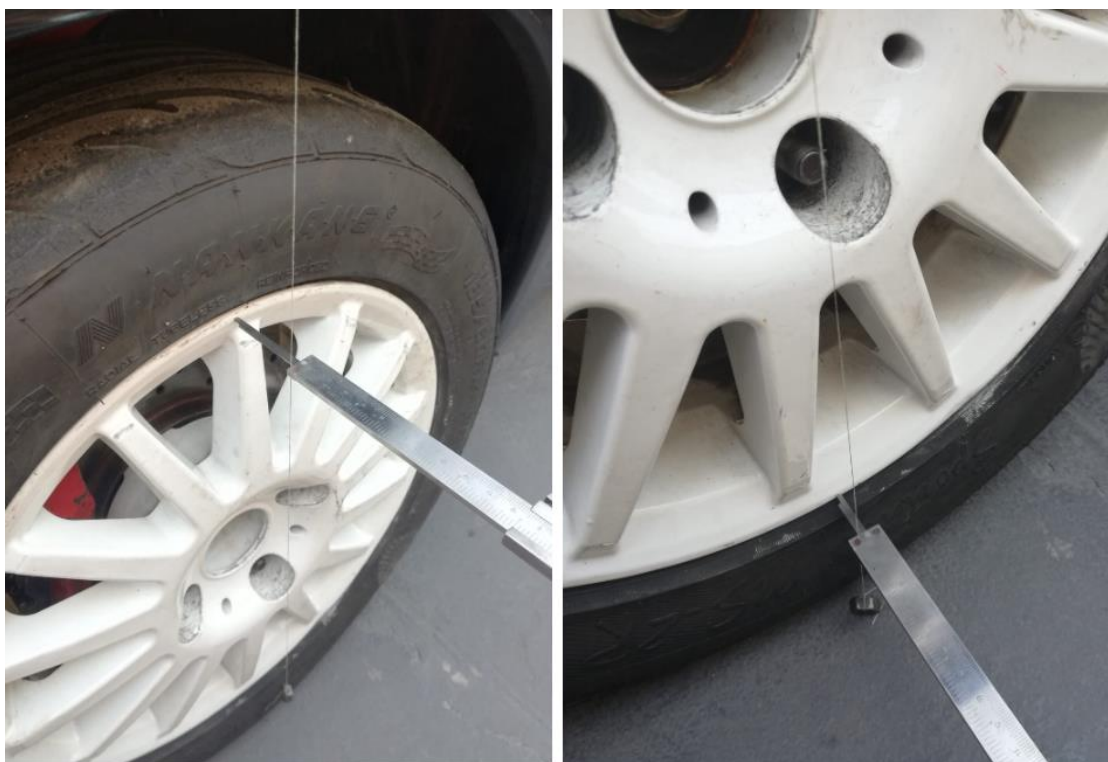
Slika 4.1. Prikaz određivanja bočnog nagiba kotača računskom metodom
