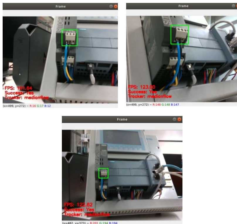
Slika 20. Praćenje rednih stezaljki PLC-a pomoću MedianFlow algoritma praćenja
