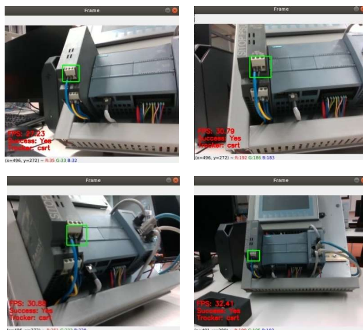
Slika 19. Praćenje rednih stezaljki PLC-a pomoću CSRT algoritma praćenja
