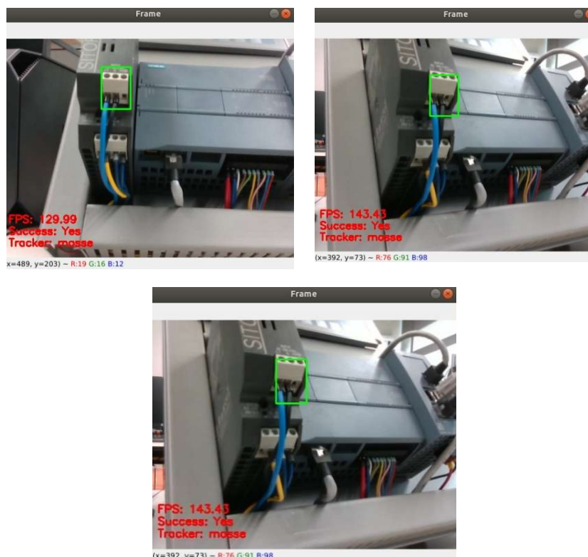
Slika 22. Praćenje rednih stezaljki PLC-a pomoću MOSSE algoritma praćenja
