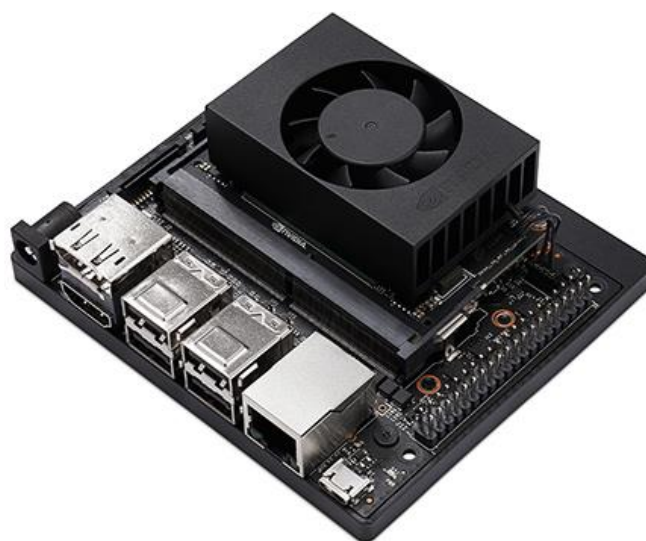
Slika 1. NVIDIA Jetson Xavier NX Developer Kit [1]
