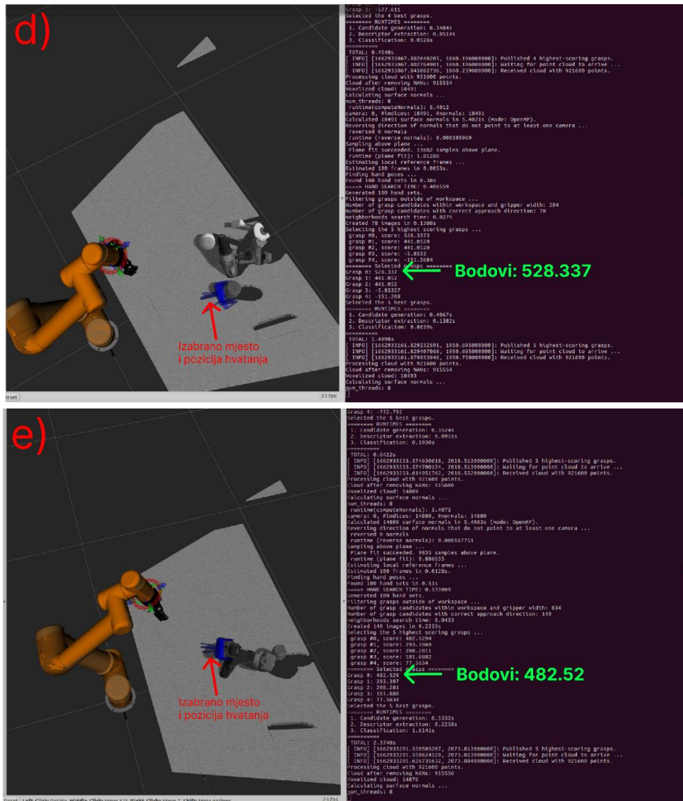
Slika 4.1 a) - e) Testiranje izlaza GPD-a za 5 različitih pozicija i orijentacija predmeta na stolu
