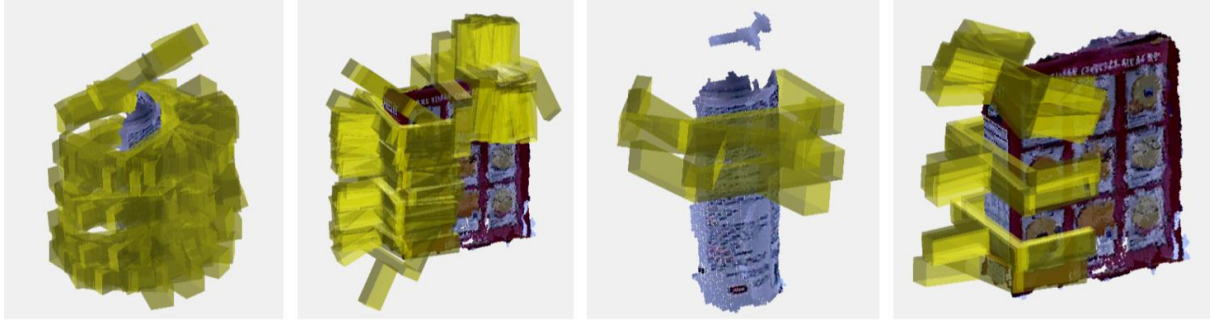
Slika 2.5 Pronađeni kandidati za hvatanje objekta - korak 3 GPD algoritma [11]
