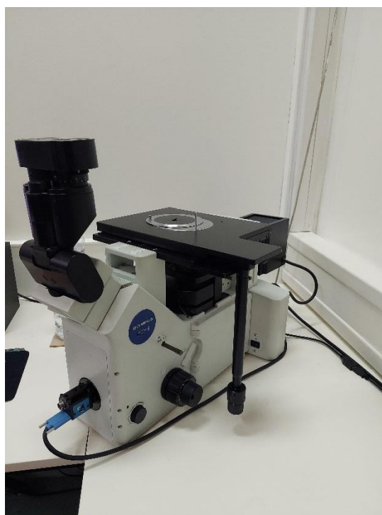
Slika 27. Invertni mikroskop Olympus GX51
