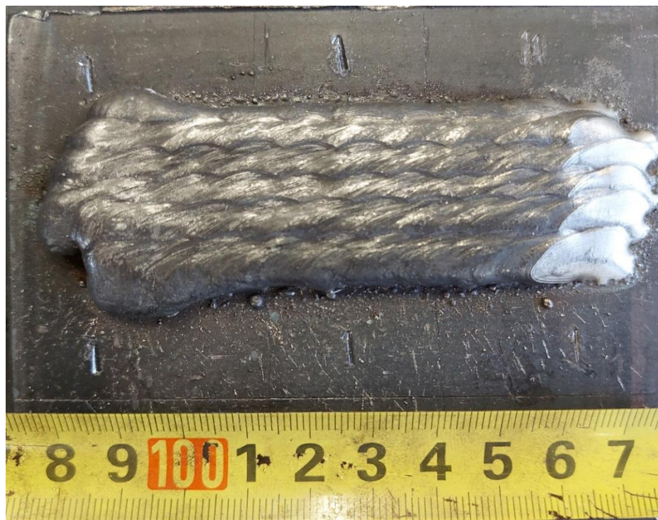
Slika 42. Uzorak 1-1 nakon zavarivanja i četkanja
