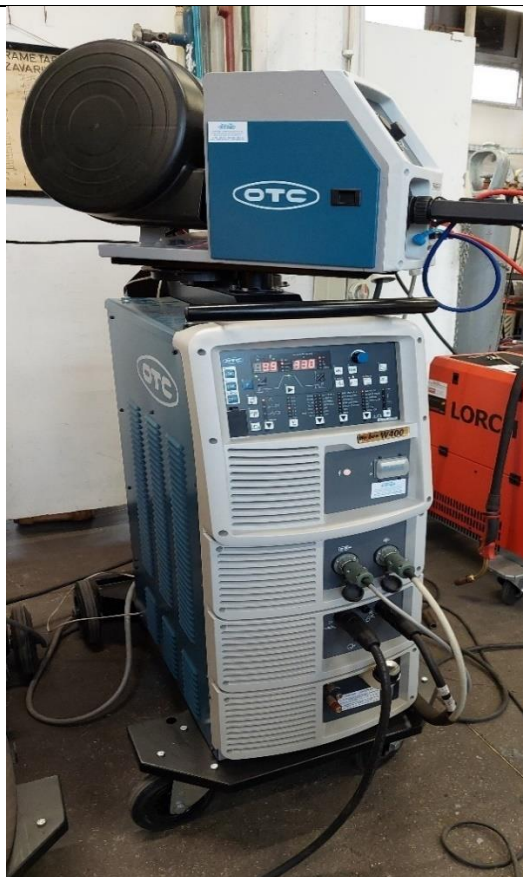
Slika 20. Izvor struje Welbee 400 proizvođača OTC – DAIHEN
