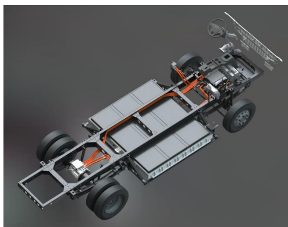
Slika 7. Šasija Newrizon električnog dostavnog vozila [6]
