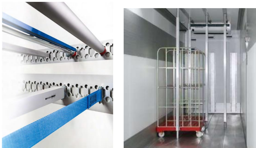
Slika 45. Vertikalno i horizontalno učvršćivanje tereta [20]
