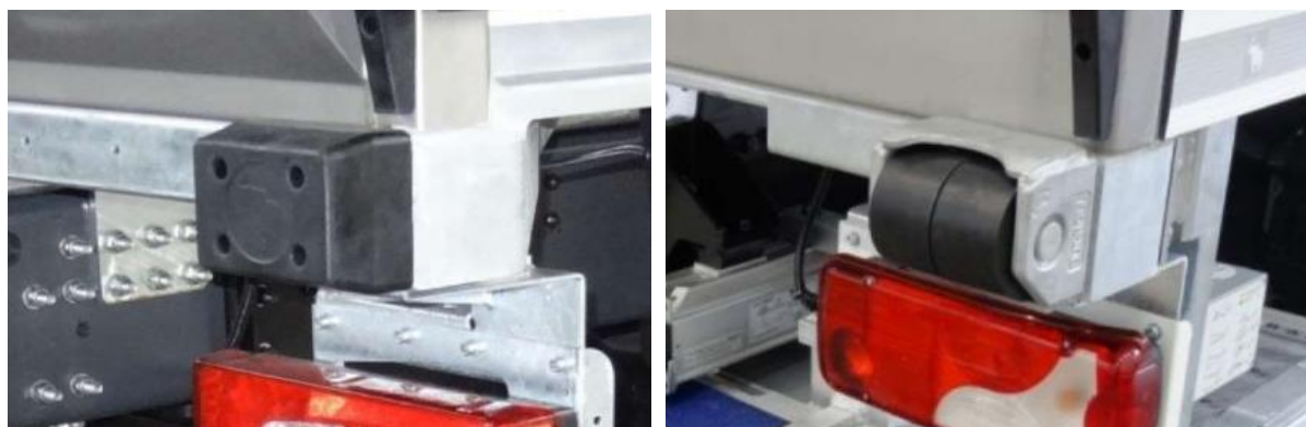
Slika 42. Standardni gumeni odbojnici (lijevo), valjkasti kutni odbojnici (desno) [22]
