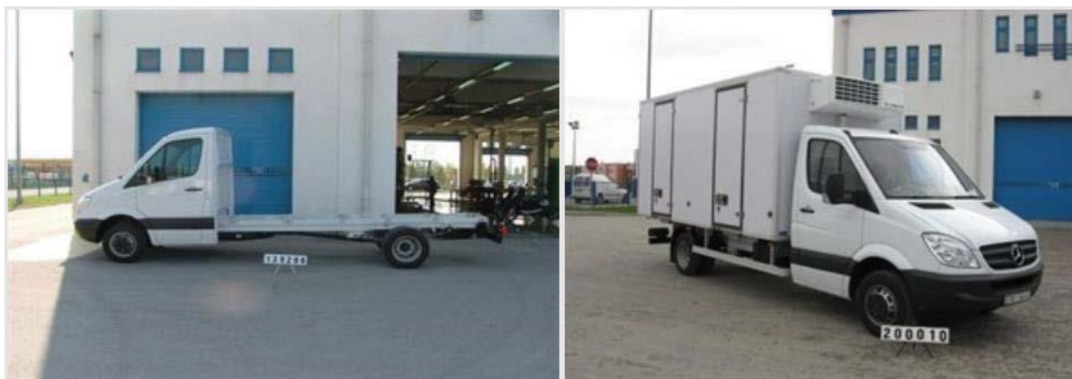
Slika 15. Višestupanjska homologacija, nepotpuno vozilo lijevo, dovršeno vozilo desno [17]
