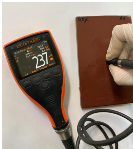
Slika 26. Postupak mjerenja debljine epoksidnog premaza
