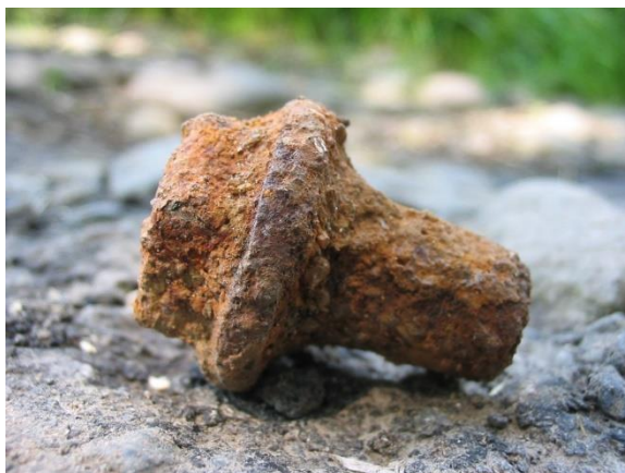
Slika 3. Opća korozija sivog lijeva [6]
