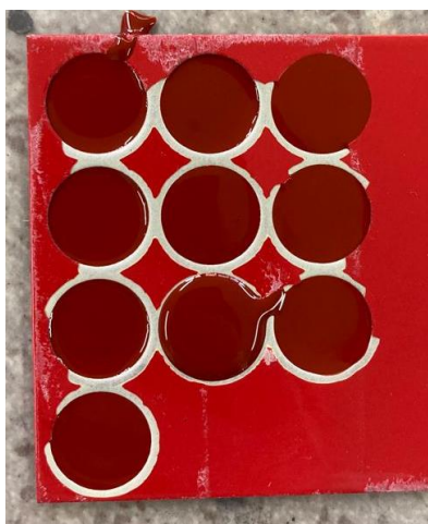
Slika 35. Uzorci za mikrobiološko ispitivanje prije procesa sušenja
