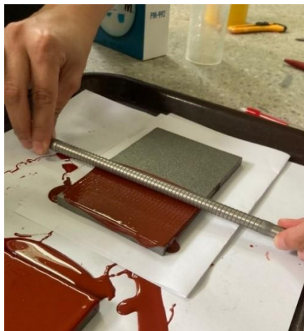
Slika 23. Nanošenje epoksidnog premaza s dodatkom nanočestica aluminija
